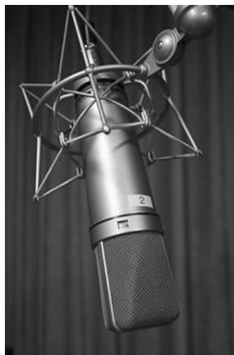
Slika 10: Primer kondenzatorskega mikrofona Vir: http://si.wikipedia/wiki/mikrofon , 14.11.2010
