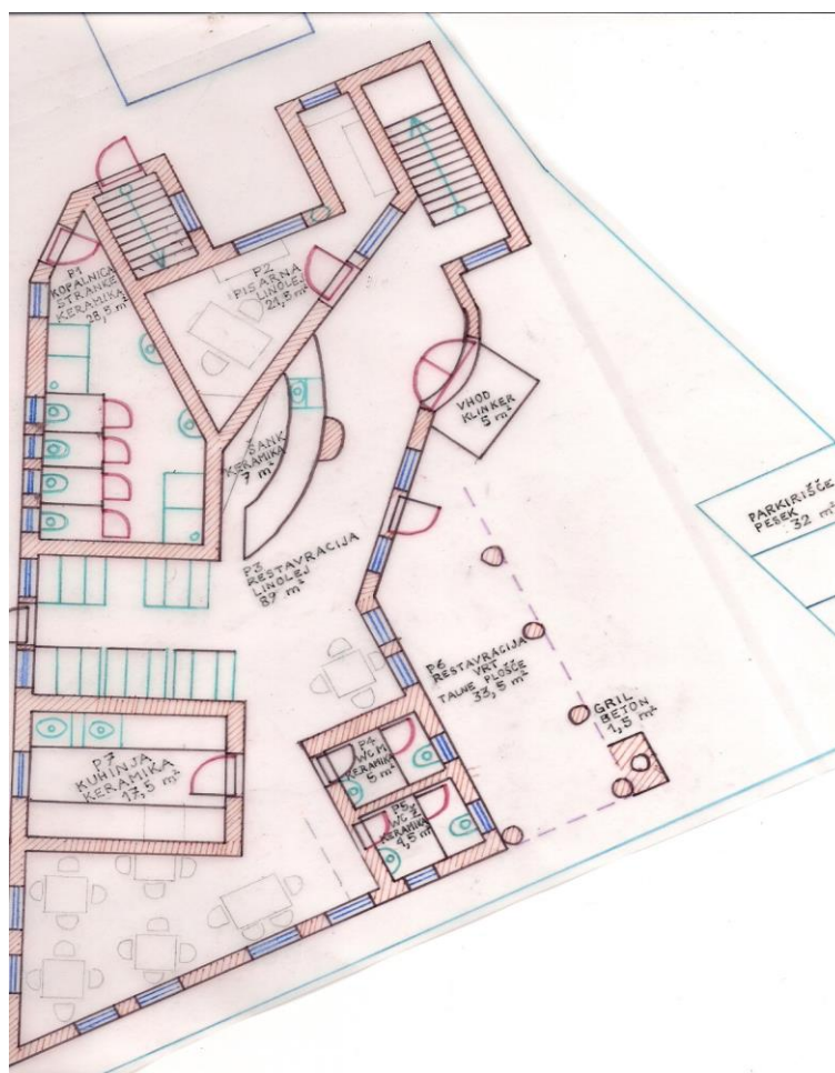
Slika 16: Pritličje poslovnega objekta s parkiriščem, vrtom restavracije
