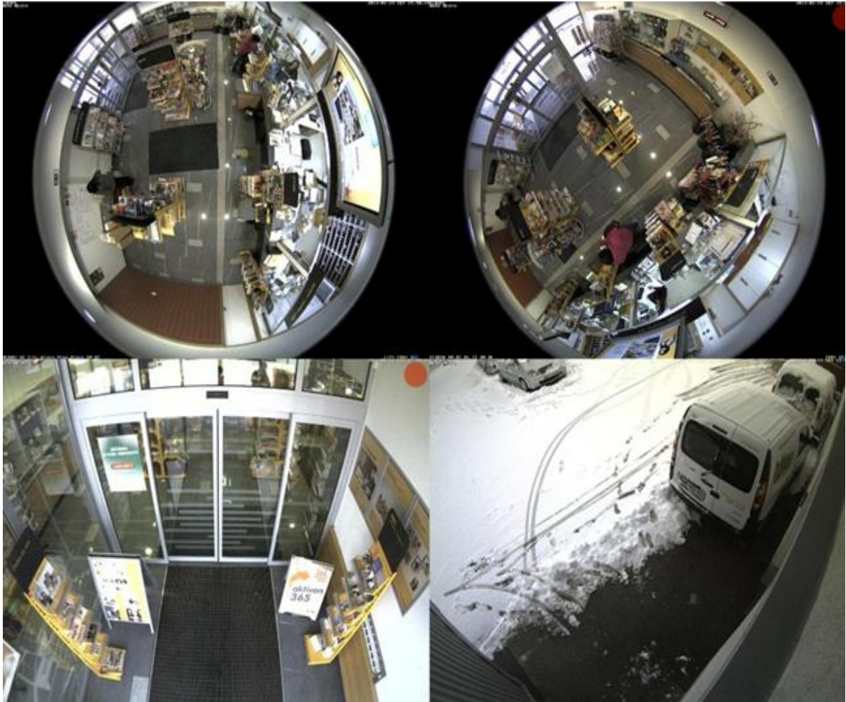
Slika 15: Primer pokritosti prostora poštne poslovalnice s štirimi kamerami
