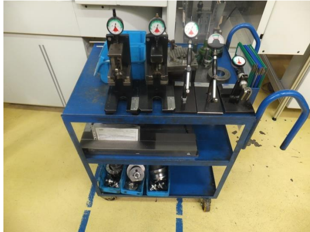
Slika 13 : Voziček z orodjem za menjavo
