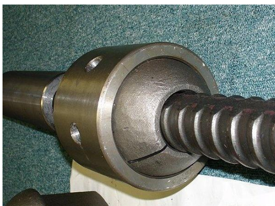
Slika 8: Prerezana matica Dywidag z objemko
