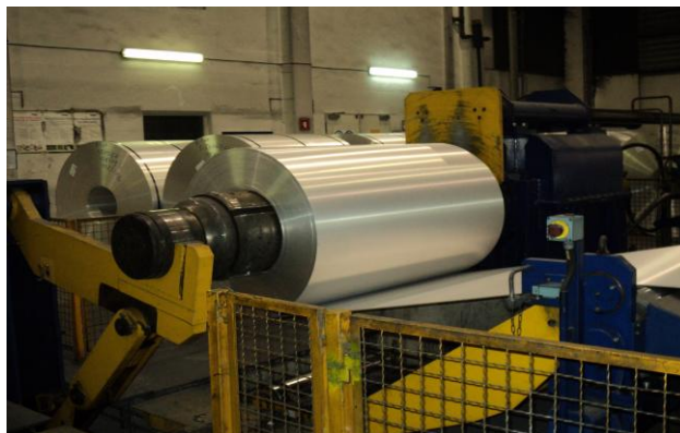
Slika 5: Miza za vpetje litega traku z navijalcem
