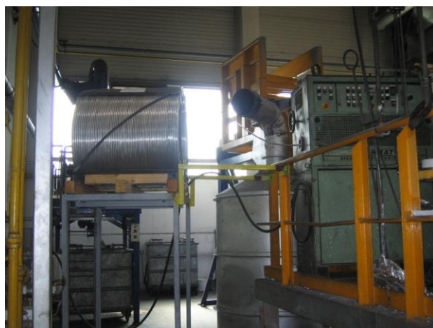
Slika 30: Legiranje taline aluminija s polnjeno Fe žico
