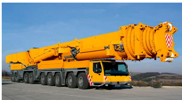
Slika 20: Avtodvigalo LIEBHERR 300ton
