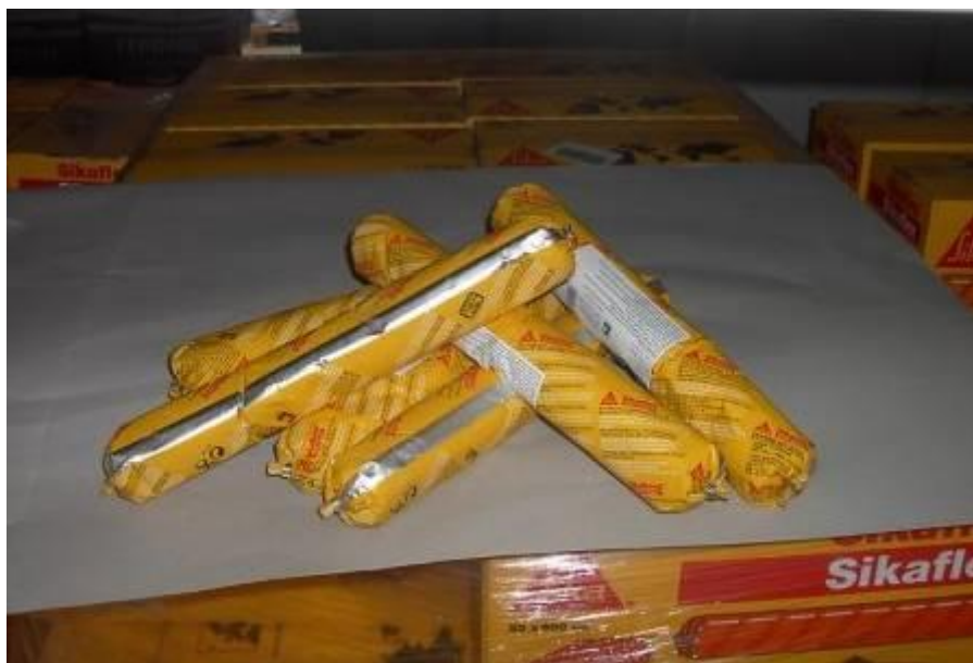
Slika 35: Trajno elastičen kit proizvajalca SIKA – kitanje stikov AB fasadnih elementov
