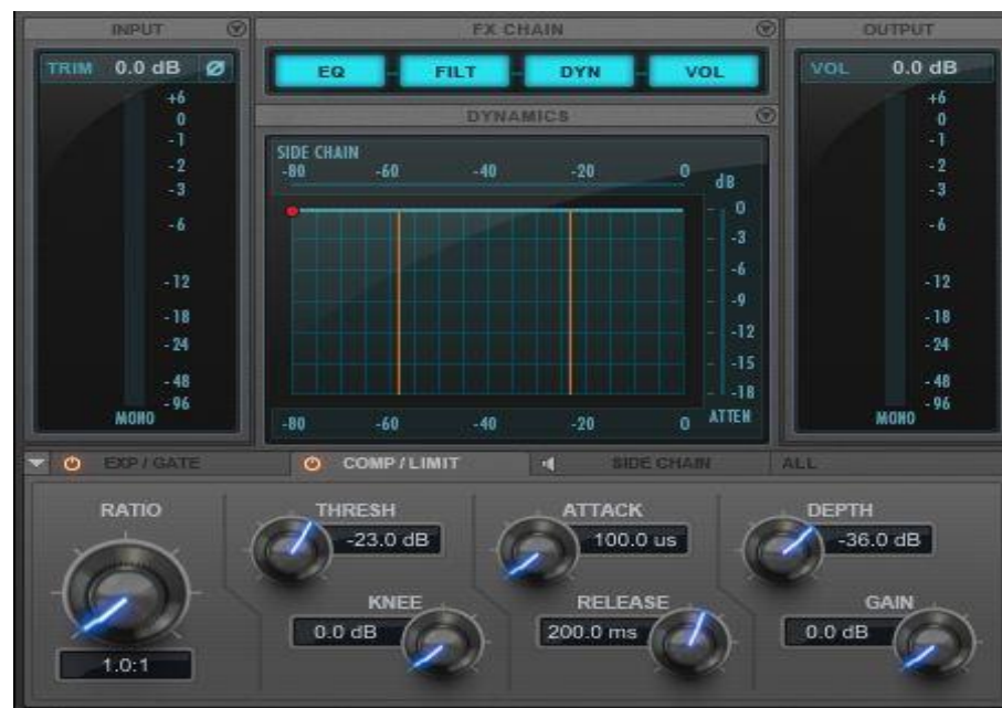
Slika 9: Primer kompresorja / limiter-ja
