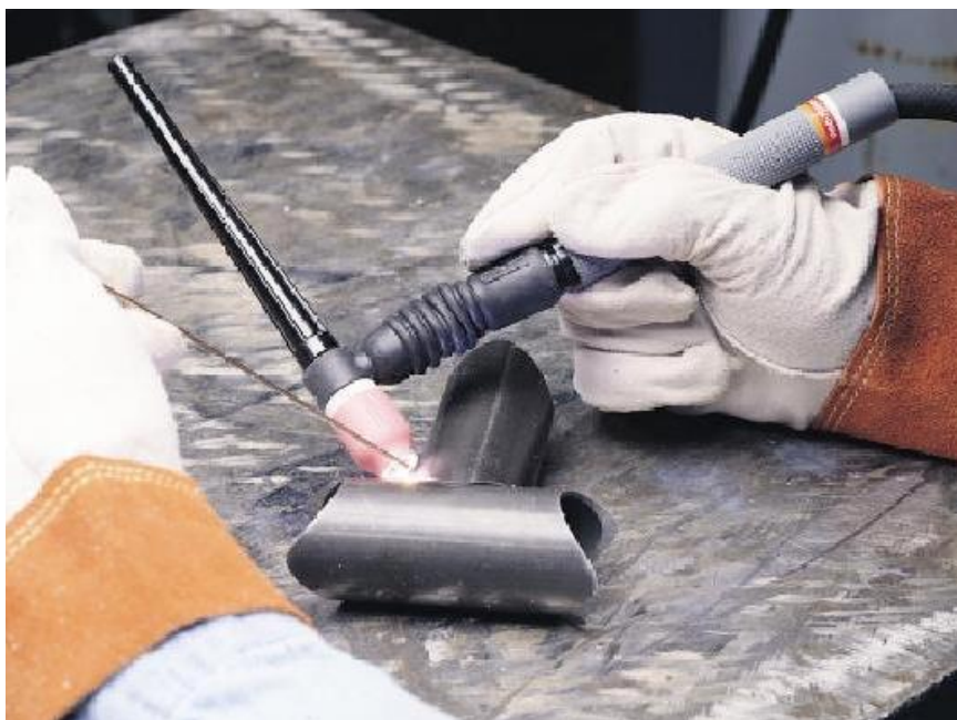
Slika 3: Varjenje po TIG postopku.
