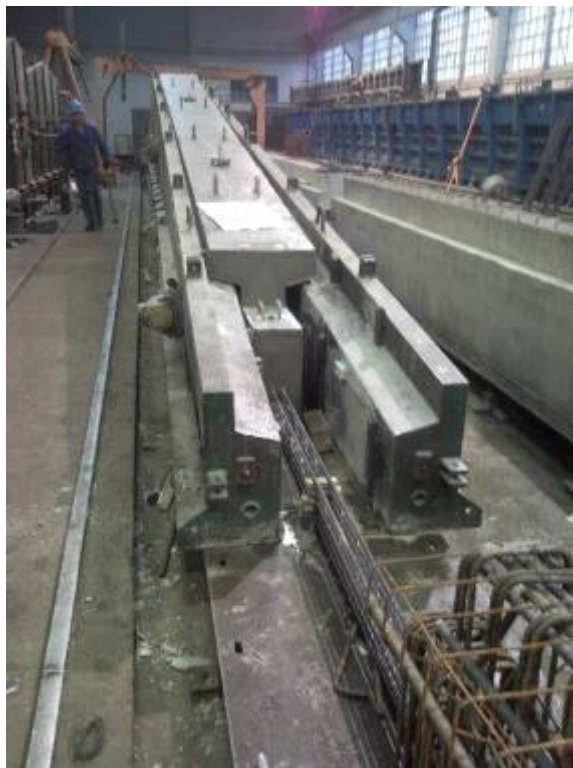
Slika 13: Razopaževanje primarnega nosilca – odstranjene čelne zapore
