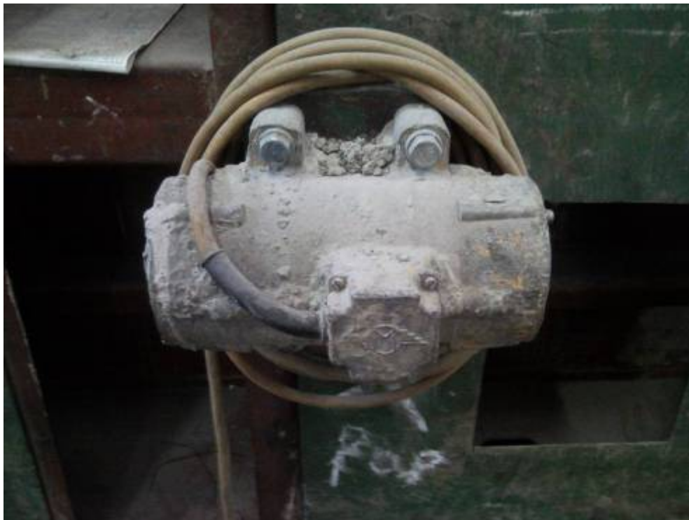
Slika 12: Vibrator vgrajen v ohišje opaža
