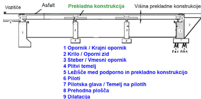
Slika 2: Prikaz podporne in prekladne konstrukcije
