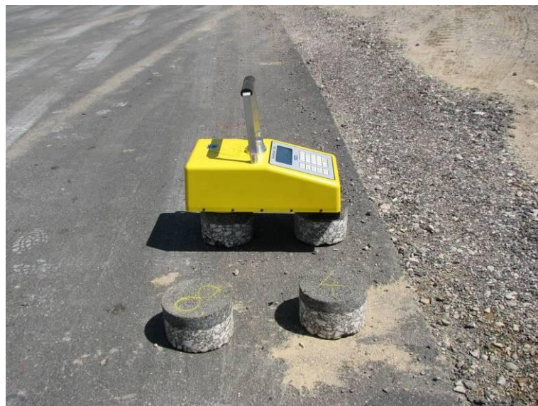
Slika 14: Primer meritev zgoščenosti neposredno na vrtinah ( \Phi 150\text{mm} )
