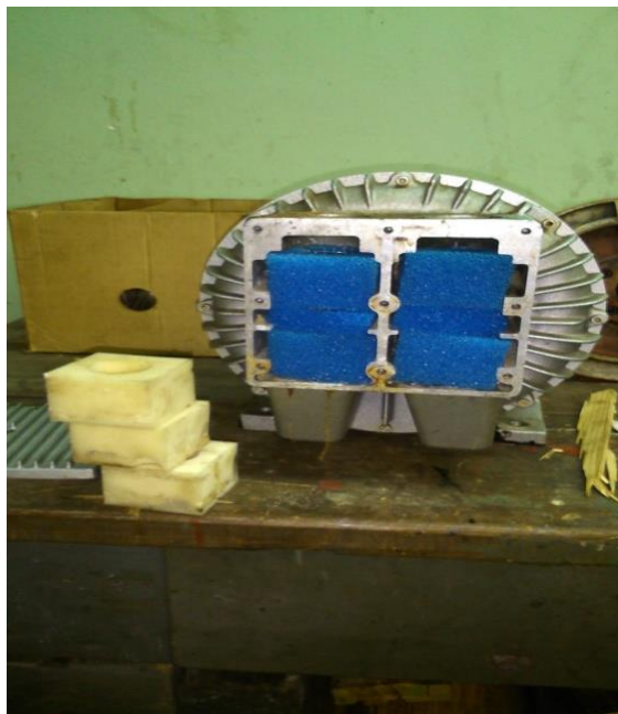
Slika 16: Ventilator oljnih par in menjava gobic
