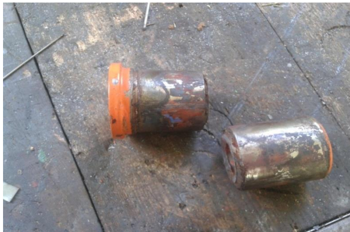
Slika 7: Lom čepa vodilnih lopat
