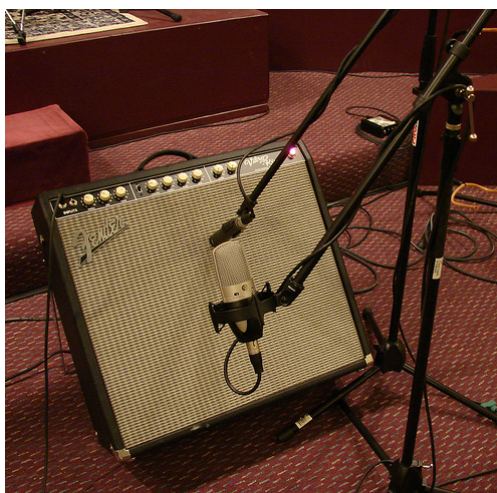
Slika 26: Postavitvena tehnika mikrofонов pri snemanju električne kitare
