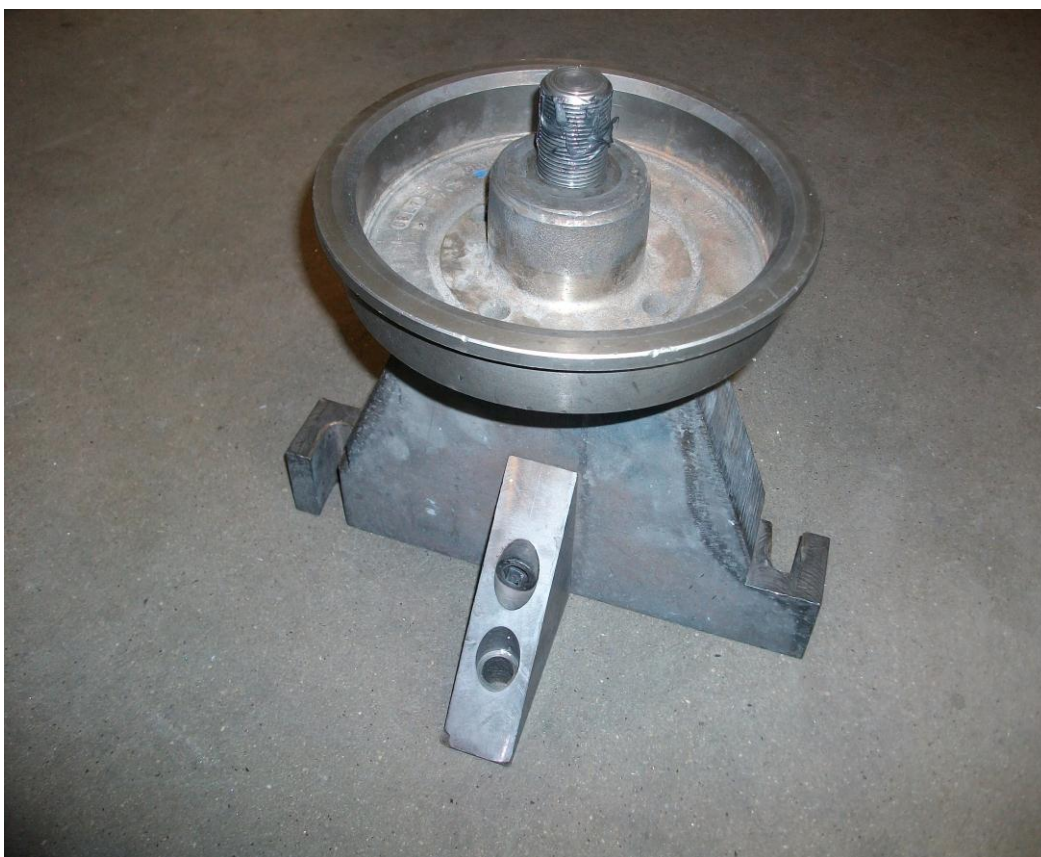
Slika 20: Zavorni boben kot tipalo senzorja
