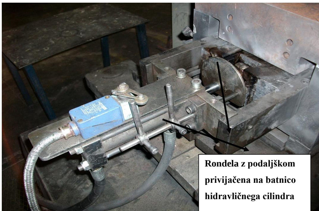
Slika 19: Signaliziranje preko batnice
