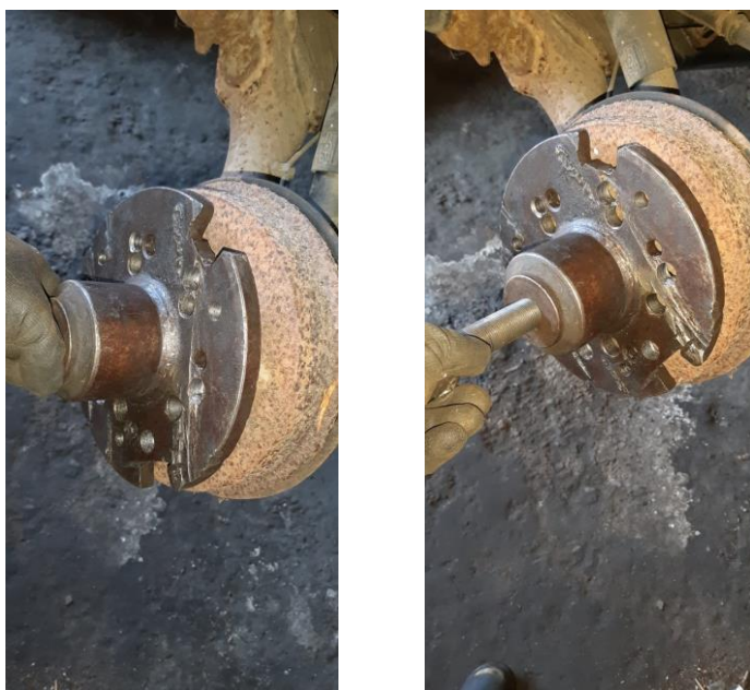
Slika 28 in slika 29: Prikaz osnove orodja za snemanje peste
