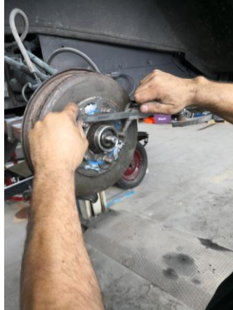
Slika 24: Merjenje odmikov navojnih palic
