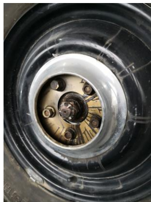
Slika 23: Odstranjen okrasni pokrov z omogočenim dostopom do vijakov za snemanje pnevmatike
