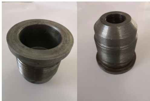
Slika 17: Povezava vretena in nosilca
