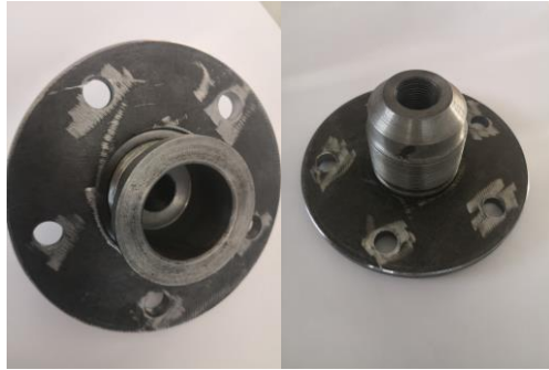
Slika 19: Nameščanje povezave in nosilca za pritrditev pesti
