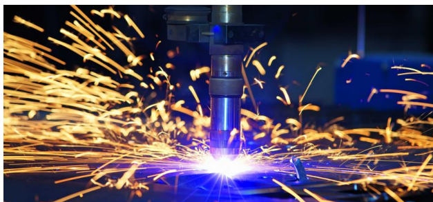
Slika 14: Rezanje z plazmo
