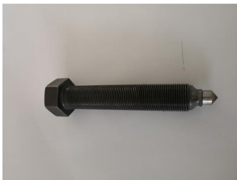
Slika 15: Vreteno orodja z dodelano sredico iz kaljenega jekla
