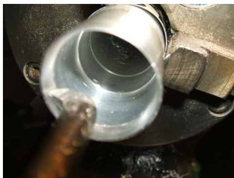
Slika 10: Rezanje notranjih navojev
