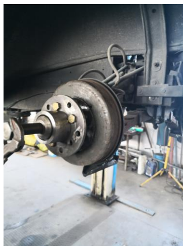
Slika 26: Nameščeno orodje na pesto avtomobila
