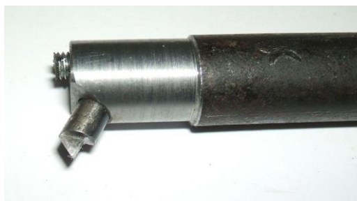
Slika 11: Orodje za rezanje notranjih navojev na stružnici
