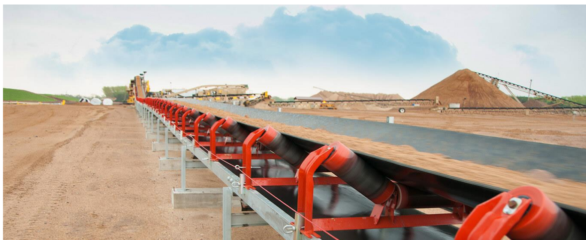
Slika 4: Tračni transporter za sipki material
