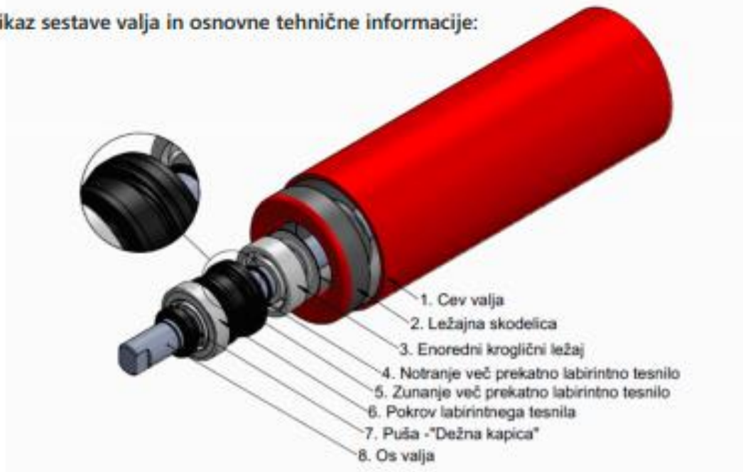
Slika 5: Transportni valj tračnega transporterja za sipki material
