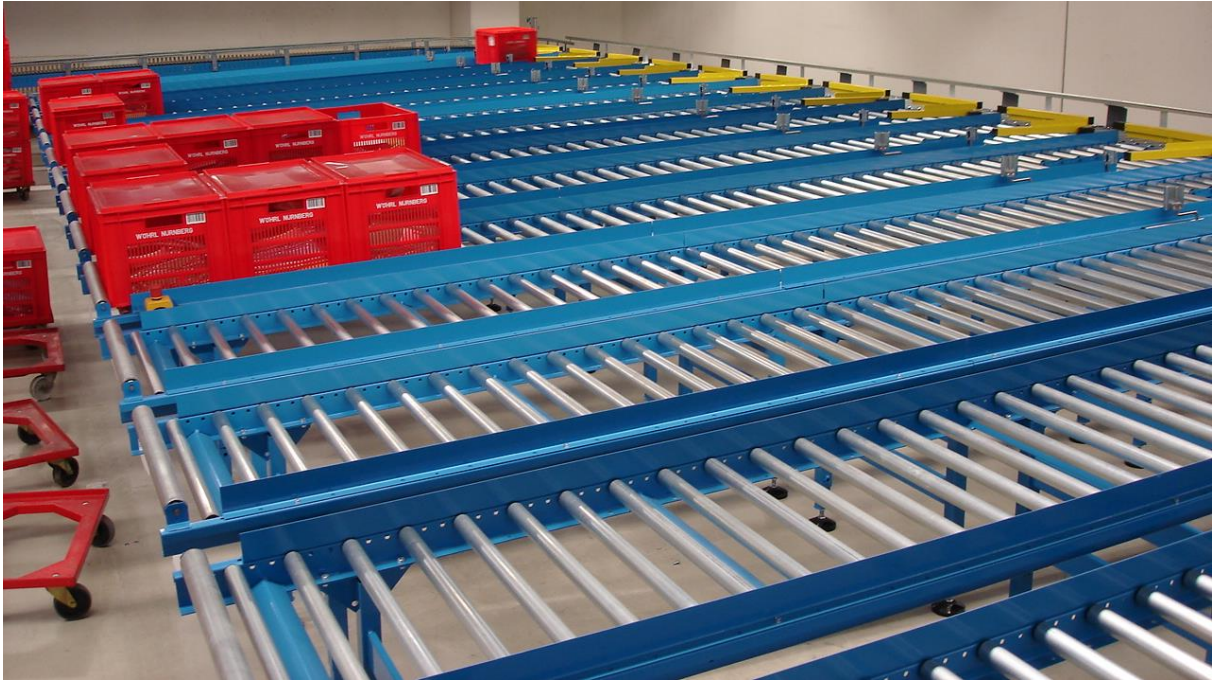
Slika 2: Gravitacijski transportni sistem
