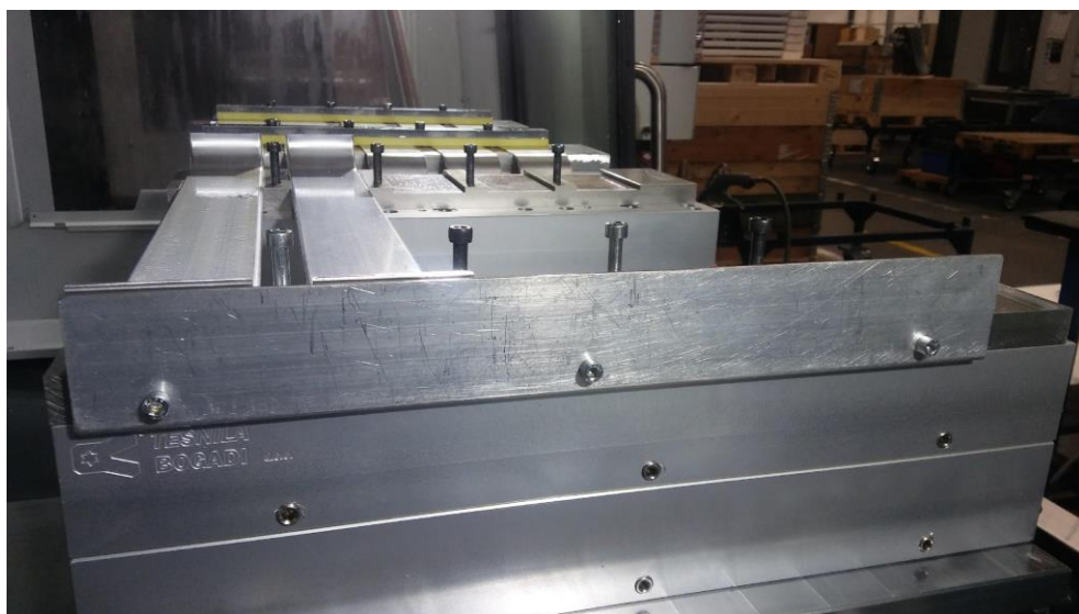
Slika 31: Pritrjen naslon na prvi del priprave
