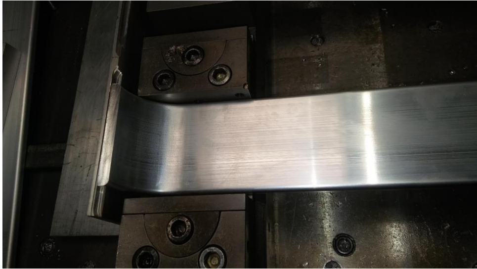
Slika 5: Vpenjanje z jeklenimi prijemali
