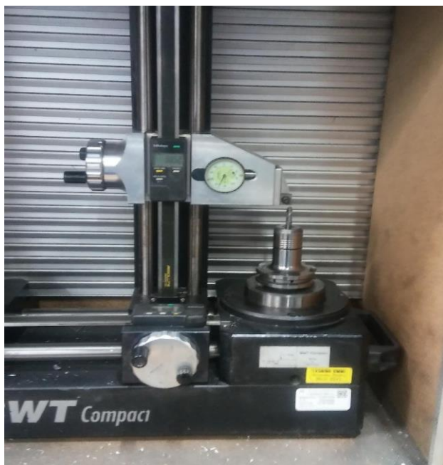
Slika 25: Naprava za merjenje orodij
