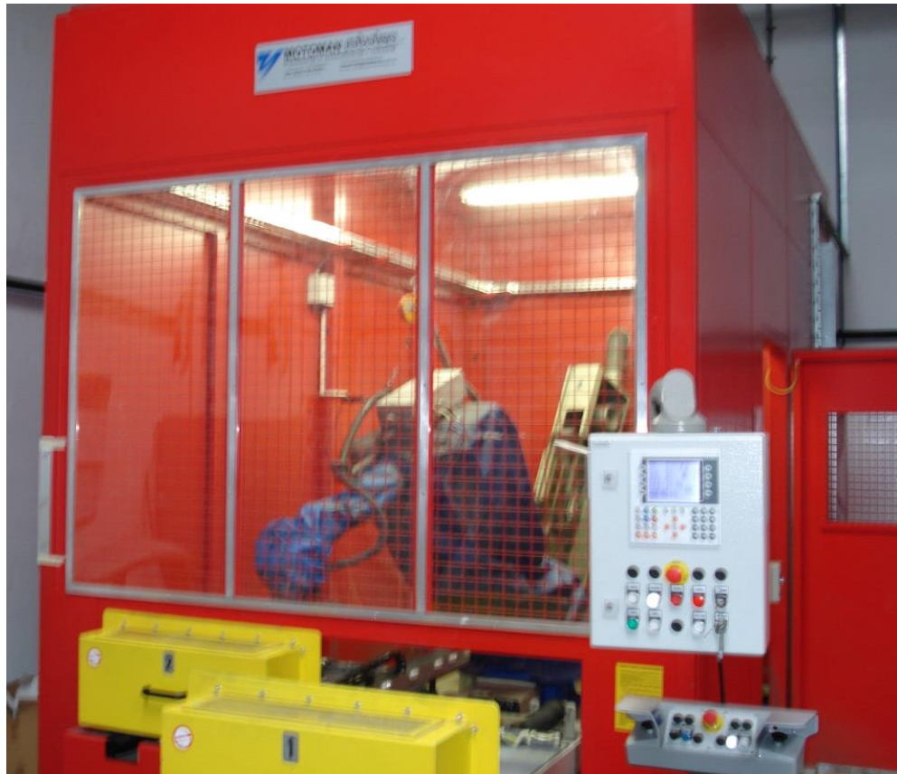
Slika 9: Robot Motoman za mokro brušenje
