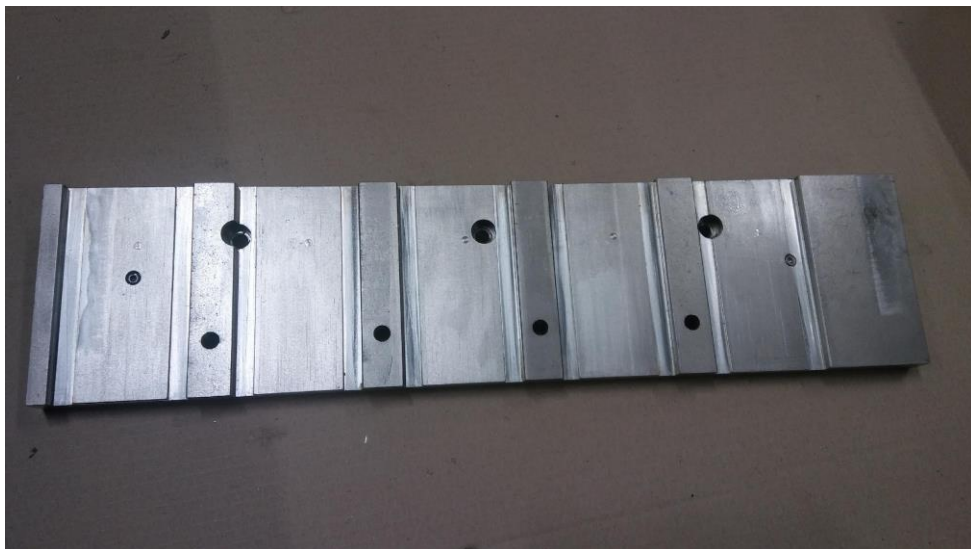
Slika 38: Korekcija vpenjalne priprave s posnetjem
