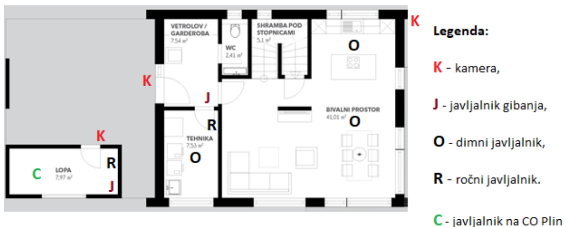
Slika 3: Prikaz postavitve tehničnega varovanja v pritličju
