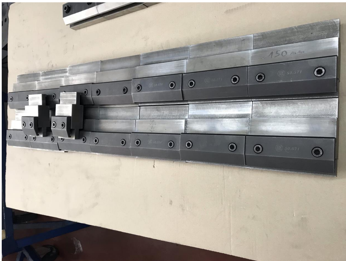
Slika 17: Vpenjalni pritrdilni elementi in vijaki istega tipa
