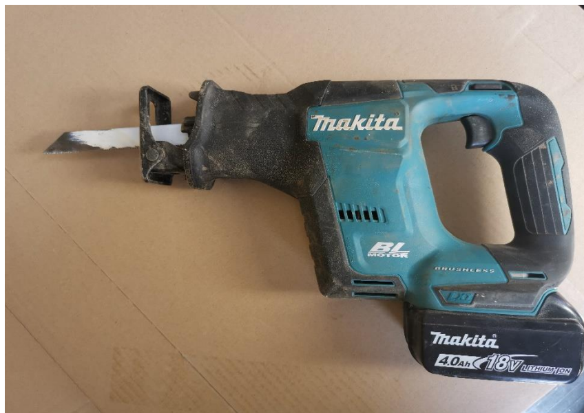
Slika 2: Žaga – sabljasta, primerna za rušenje in rezanje
