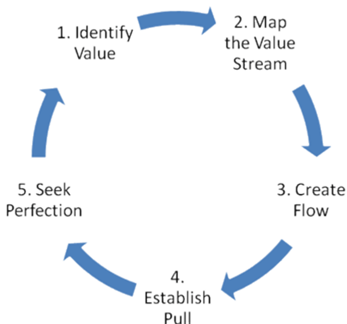
Slika 1: Pet ključnih načel vitke proizvodnje
