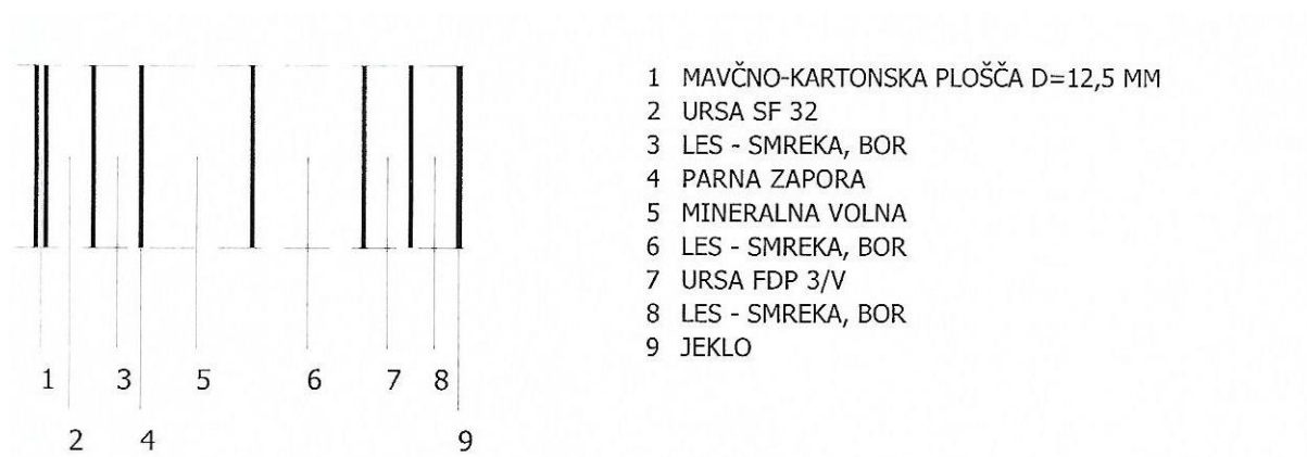
Slika 15: Sestava zunanjega zidu pri modularni vikend hiši
