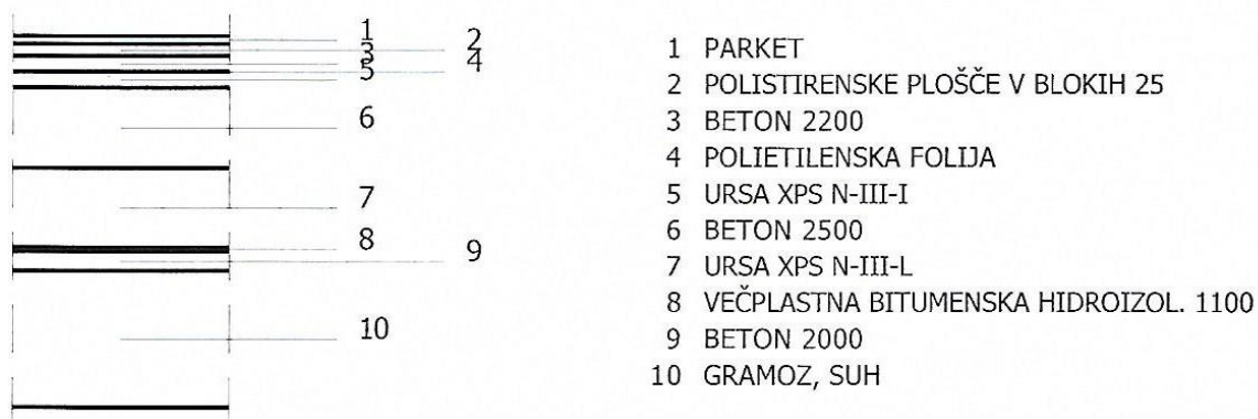
Slika 16: Sestava talne plošče pri modularni vikend hiši
