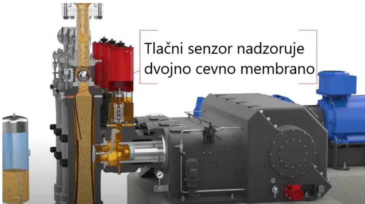
Slika 12: Tlačni senzor membranske črpalke SG 130 – 2 DS17
