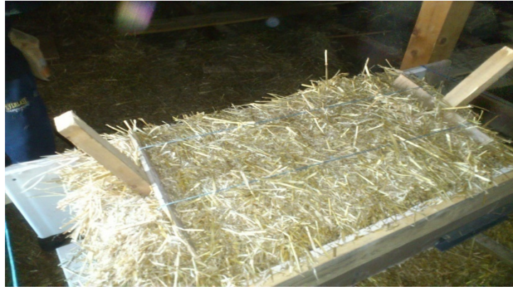
Slika 52: Naprava za striženje slamnatih bal
