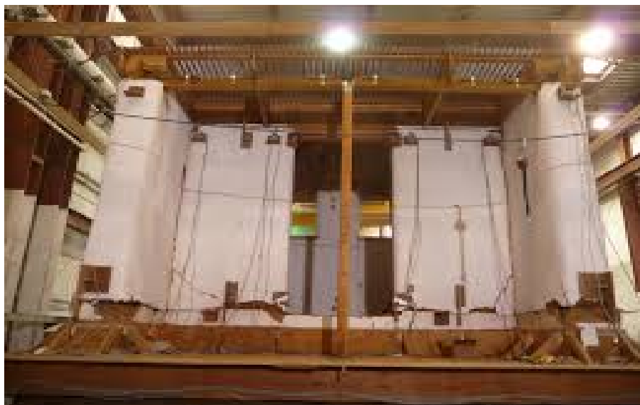
Slika 38: Simulacija potresa na samonosilni konstrukciji iz slamnatih bal
