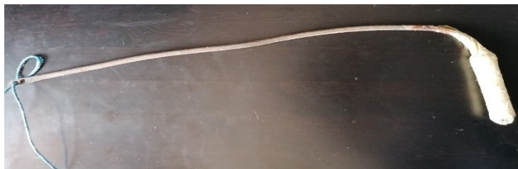
Slika 39: Igla za ponovno šivanje slamnate bale
