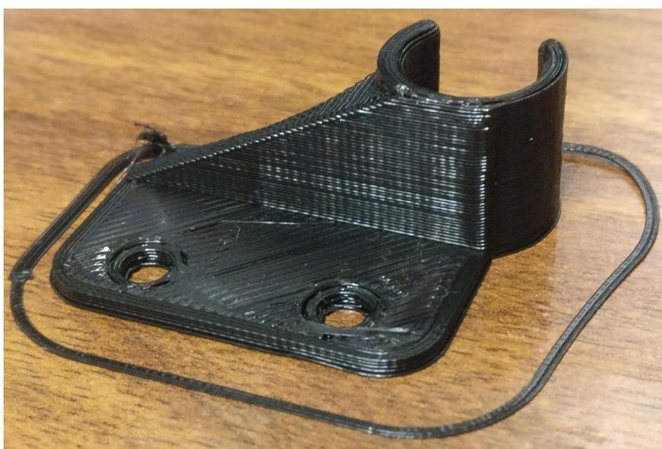
Slika 41: 3D-tiskan model naklonskega dovoda kablov na ekstuder
