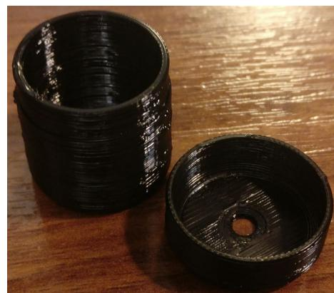
Slika 32: 3D-tiskan model prašnega filtra za filament
