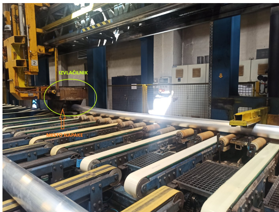
Slika 33: Izvlačilnik in mesto napake
