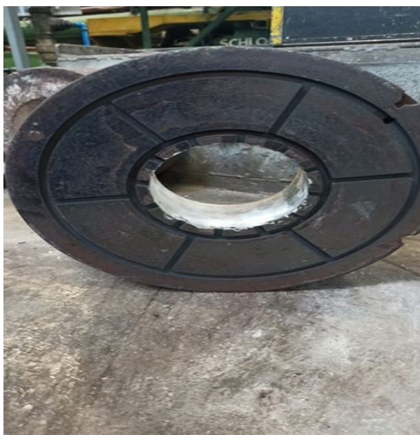
Slika 19: Kanali za dušik na ojačevalcu
