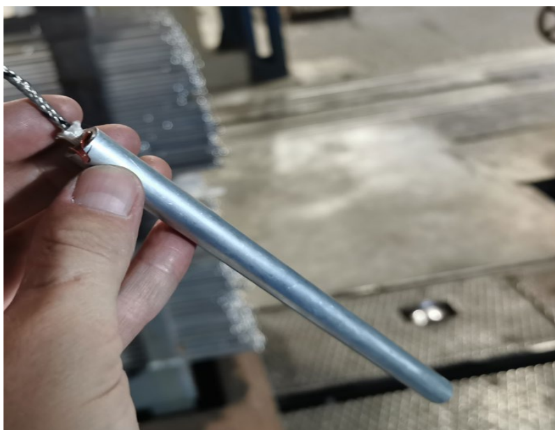
Slika 30: Termoelement tipa J
