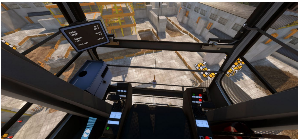
Slika 30: VR-simulacija za učenje upravljanja žerjavov – pogled znotraj kabine
