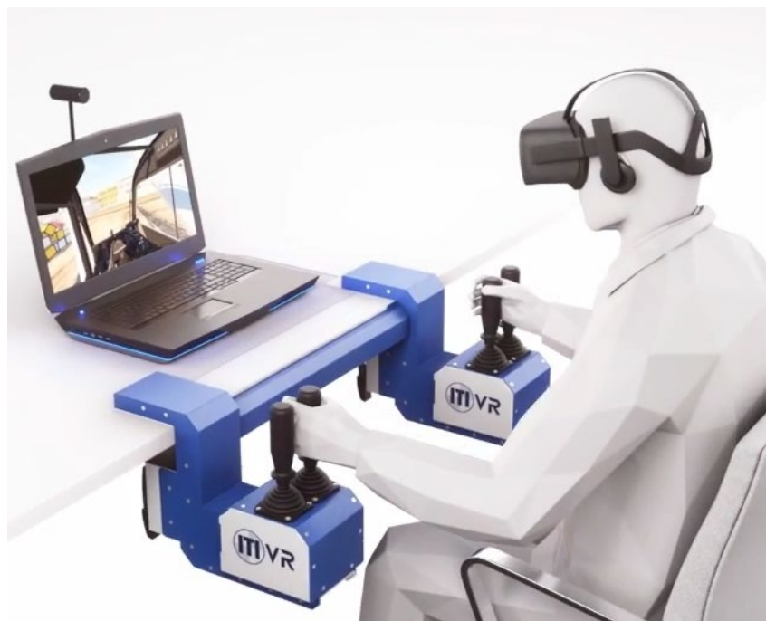
Slika 27: Konfiguracija VR-postaje z uporabo računalnika in posebnih krmilnikov IT VR
