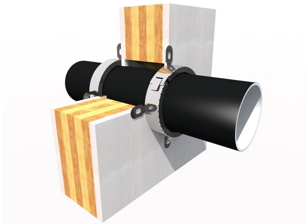
Slika 6: Prikaz namestitve manšet na PP cev, ki poteka skozi X-lam zid, obojestransko obložen z mavčno-kartonskimi ploščami
