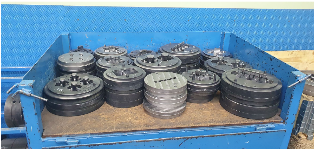
Slika 8: Komorna in nekomorna orodja za ekstruzijo.
