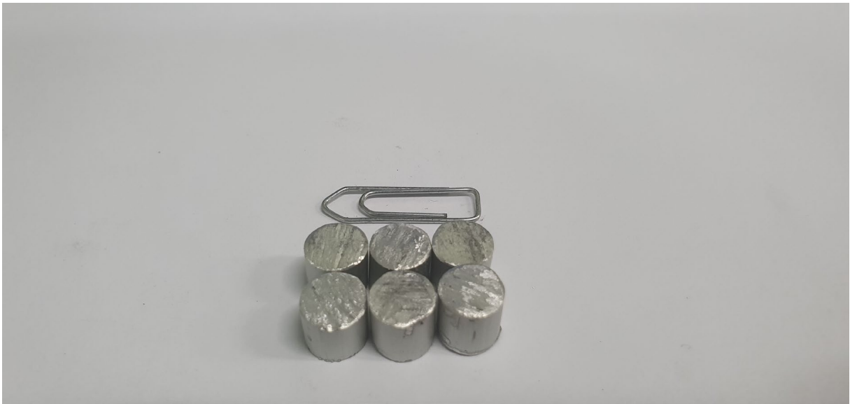
Slika 38: Vzorci aluminijeve zlitine 1,4 g/kom.
