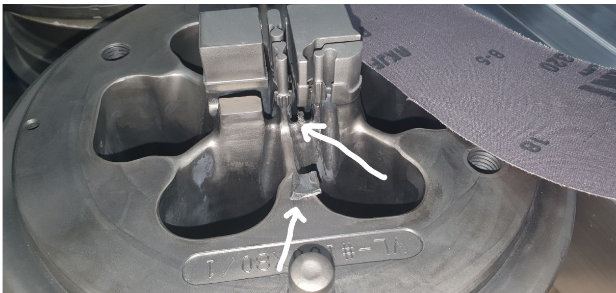
Slika 12: Prikaz poškodovanega trna orodja za odpis.
