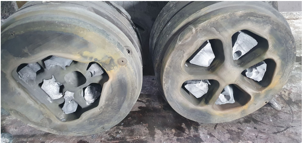
Slika 30: Prikazano odstopanje aluminija od orodja.
