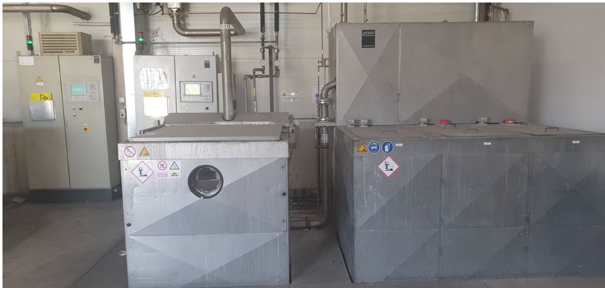
Slika 27: Komorni sistem čiščenja aluminijevih zlitin z natrijevim hidroksidom.
