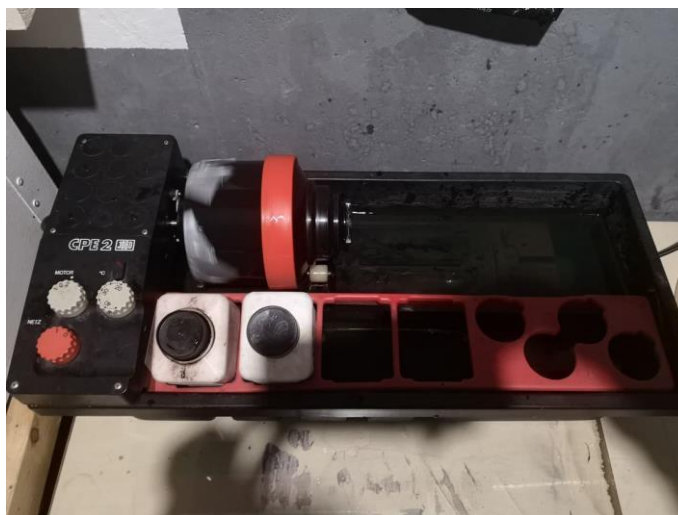
Slika 43: Razvijanje s pomočjo bobna
