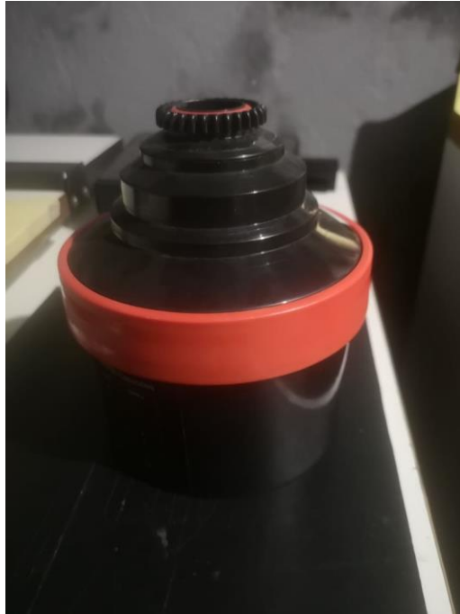
Slika 40: Zunanost bobna, v katerega vstavimo negative
