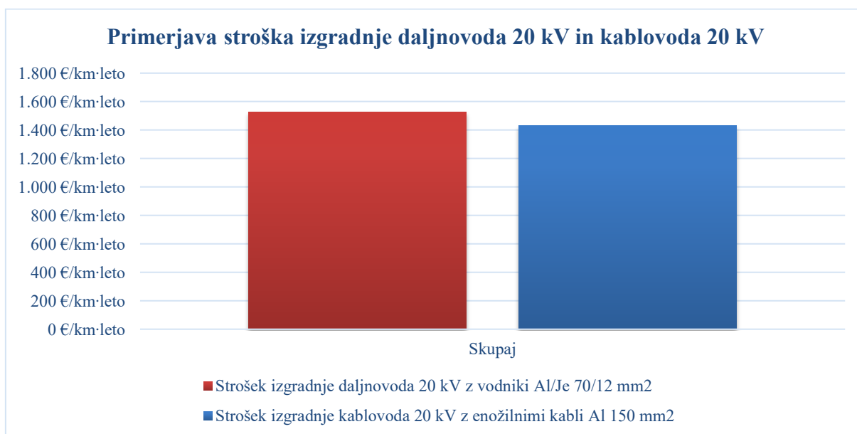
Grafikon 5.5: Primerjava stroška izgradnje daljnovid 20 kV z vodniki Al/Je 70/12 mm 2 in kablovoda 20 kV z enožilnimi kabli Al 150 mm 2 na kilometer na leto glede na življenjsko dobo
