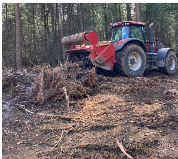
Slika 24: Izvajanje mletja panjev in grmičevja
