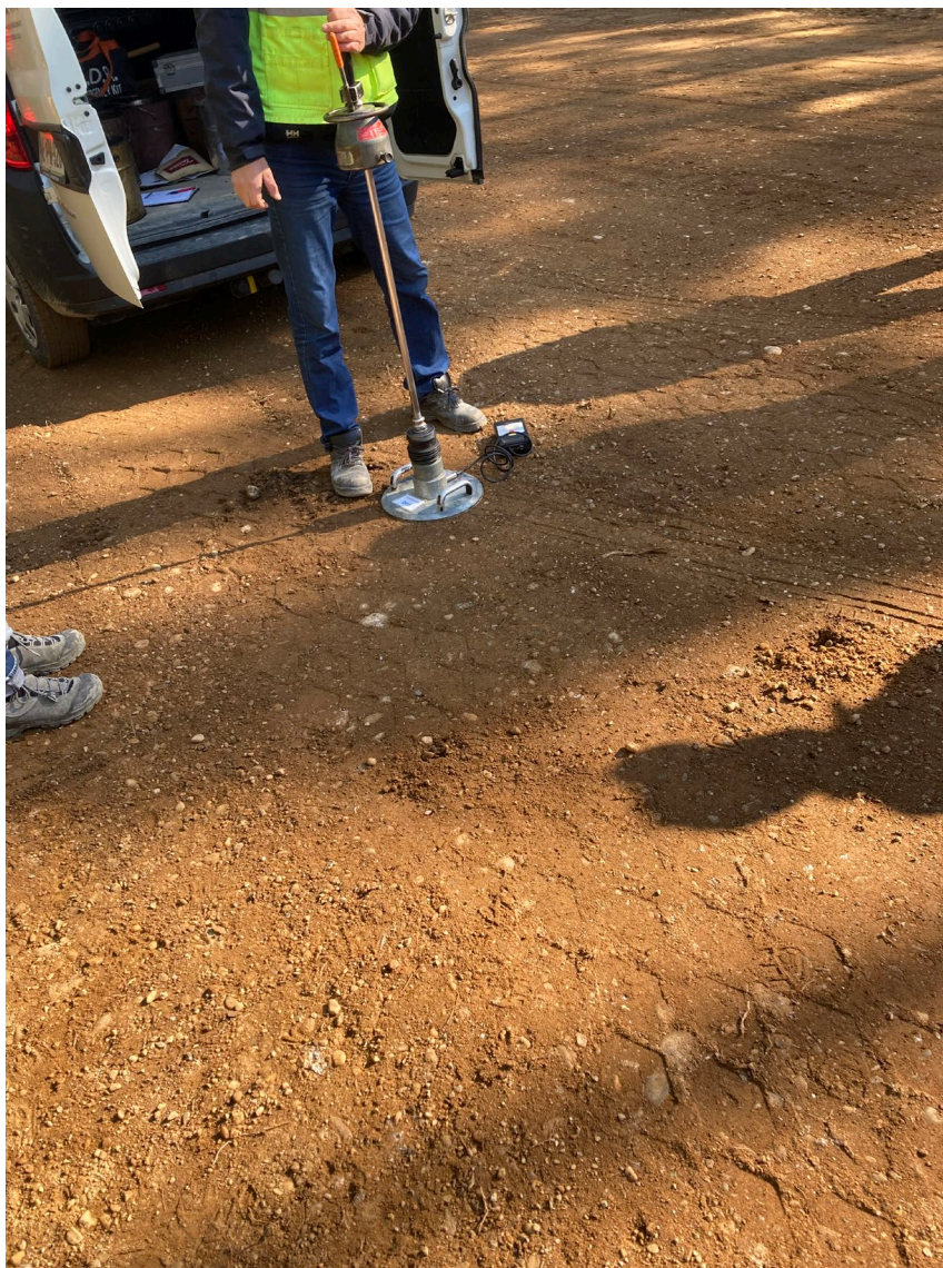
Slika 22: Merjenje nosilnosti in zgoščenosti tal z dinamično ploščo
