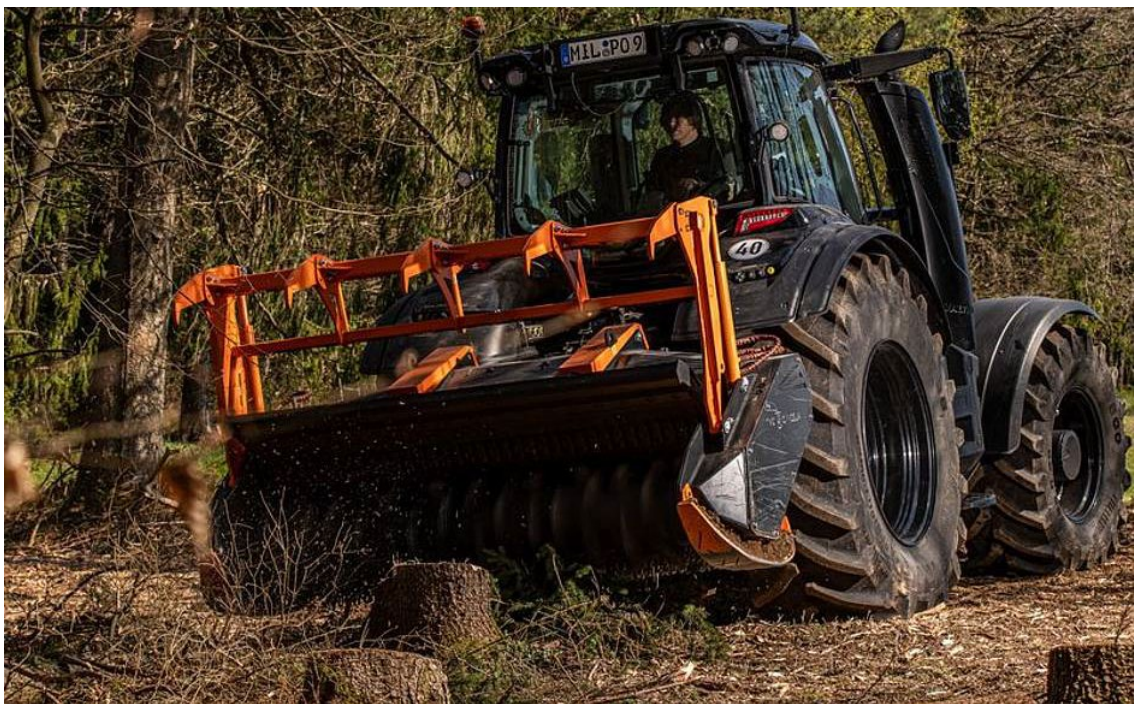
Slika 25: Freza za mletje panjev in grmičevja
