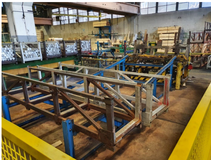
Slika 20: Razkladalna rampa za prazne okvirje
