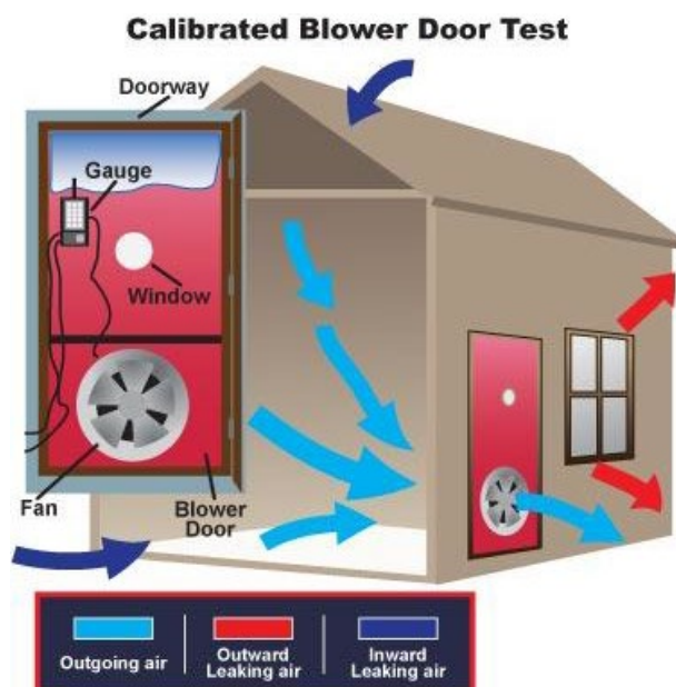
Slika 12: Blower door test
