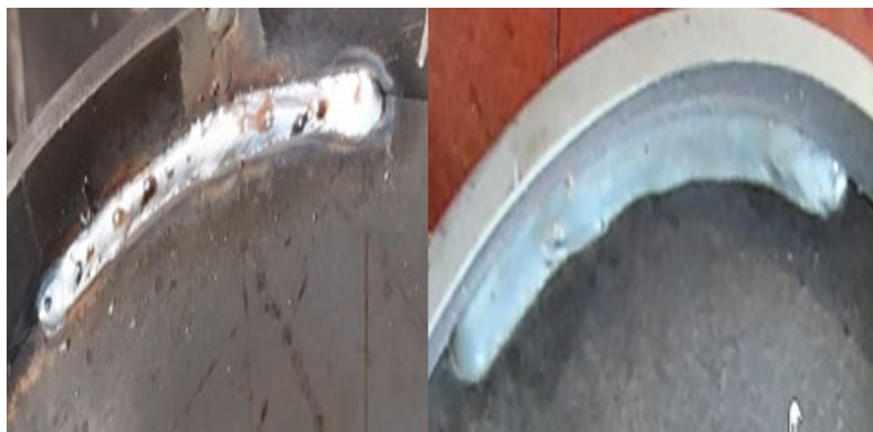
Slika 32: Primerjava zvara na zavornem obroču
