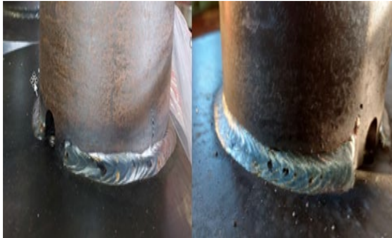
Slika 33: Ročni način izdelave (levo) in robotski (desno)
