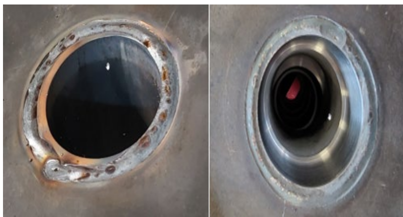
Slika 31: Primerjava zvara med ročnim in robotskim načinom izdelave
