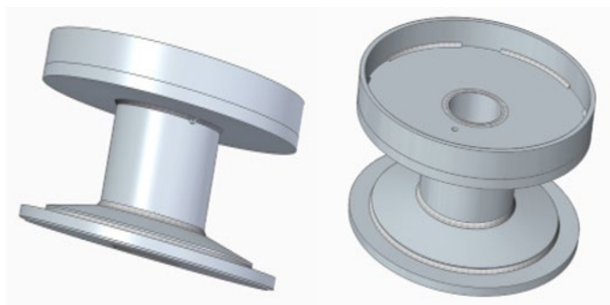
Slika 14: 3D model vravnega bobna z zvari
