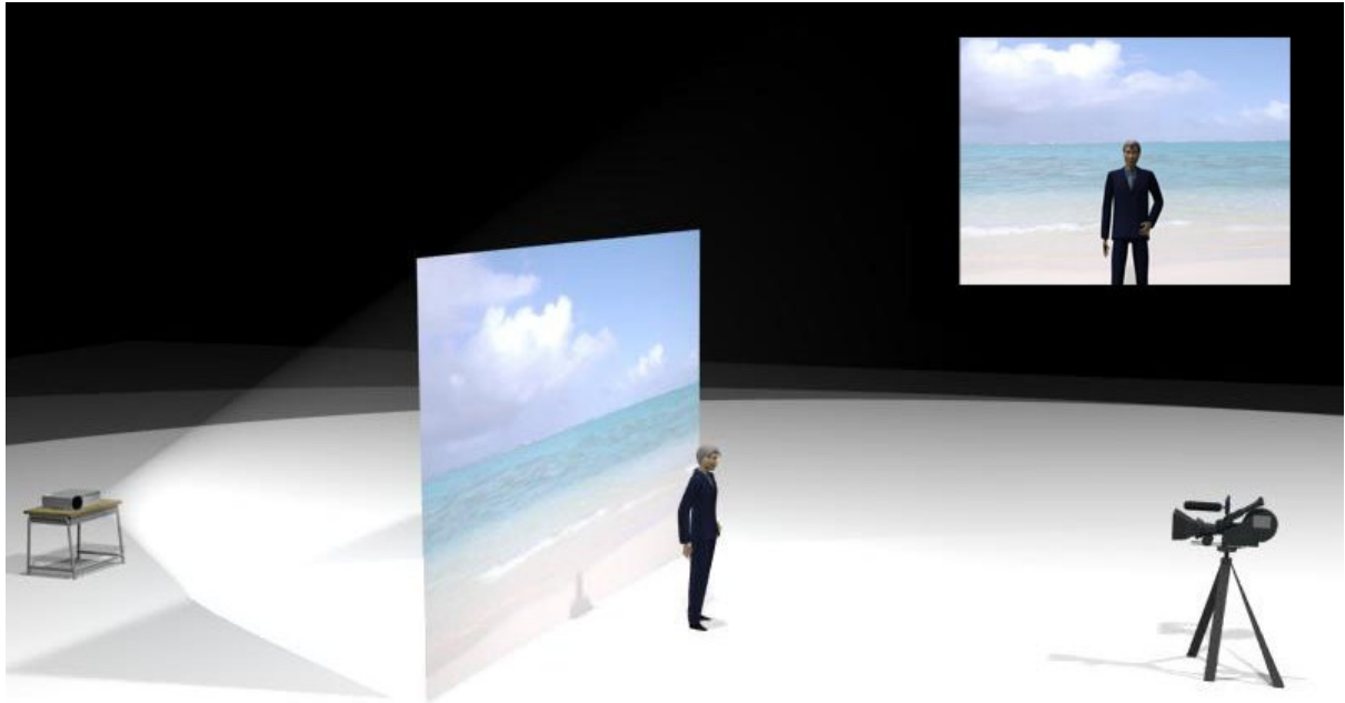
Slika 5: Tehnični prikaz uporabe projiciranja ozadja
