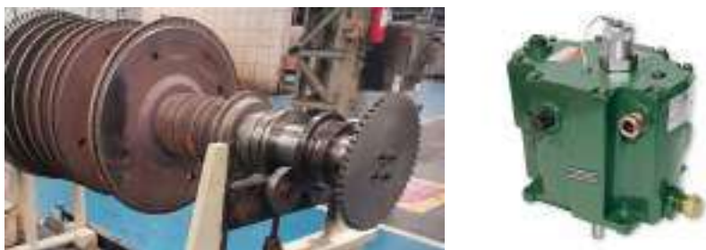
Slika 10: Prikaz zobnika za sledenje hitrosti gredi in mehanskega regulatorja
