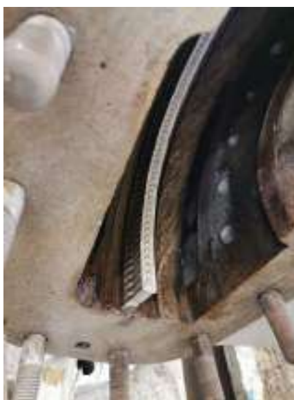
Slika 12: Prikaz pritrjene diafragme na ohišje parne turbine
