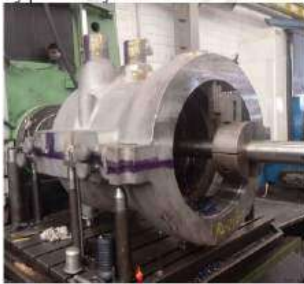
Slika 5: Ohišje parne turbine na obdelovalnem stroju
