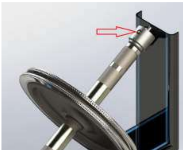
Slika 11: Prikaz zatiča za prisilno zaustavitev parne turbine
