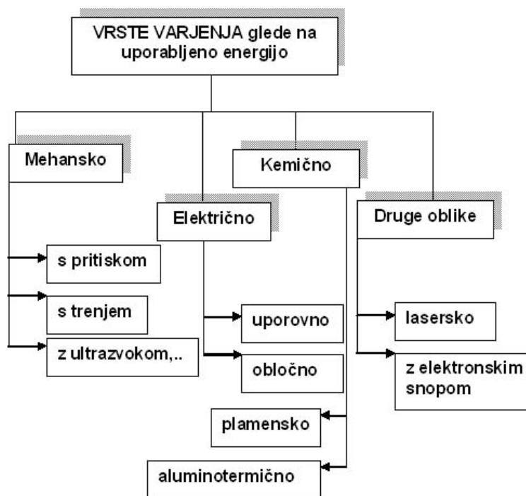
Slika 8: Vrste varjenja glede na uporabljeno energijo
