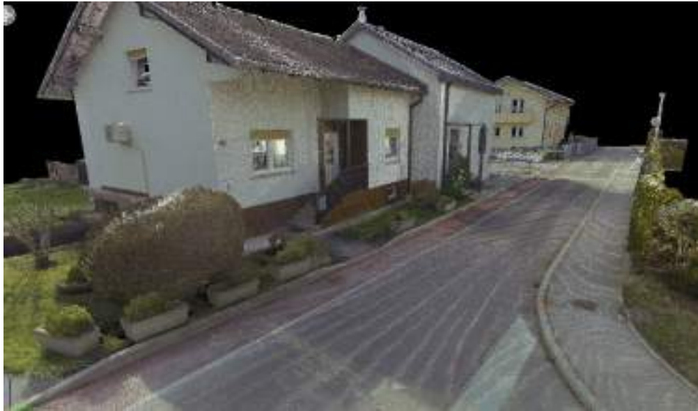
Slika 26:Oblak točk, primeren za nadaljnjo uporabo
