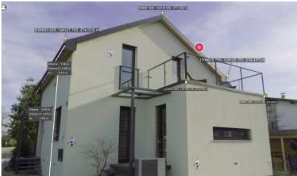
Slika 25 Prikaz izmere in poljubne georeferencirane točke na objektu
