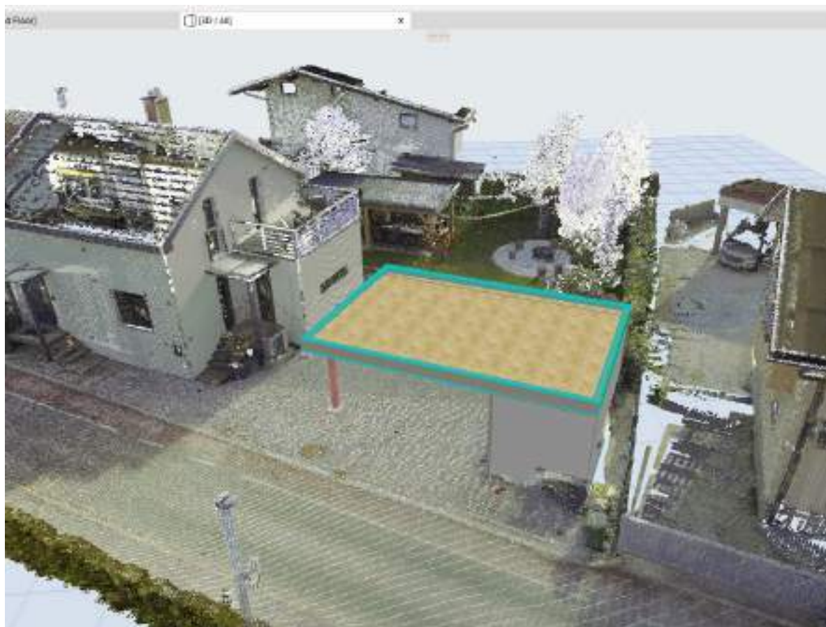
Slika 39 Pogled postavitve modela nadstreška projektiranega na oblaku točk
