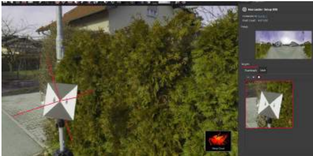
Slika 22 Prikaz stabilne črno-bele tarče in virtualna tarča za potrebe georeferenciranja oblaka točk
