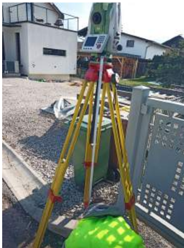
Slika 10 Prikaz stabilizacije instrumenta - tahimeter Leica GS09
