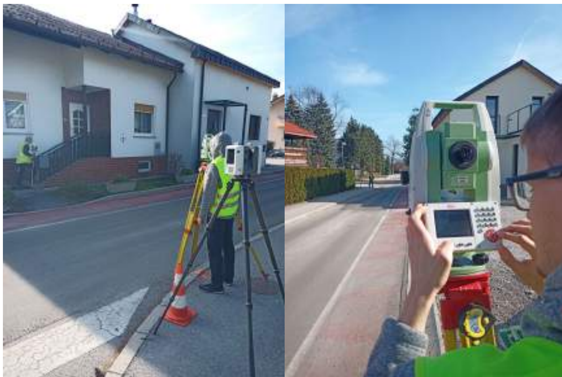
Slika 11 Prikaz geodetske izmere s tahimetrom
