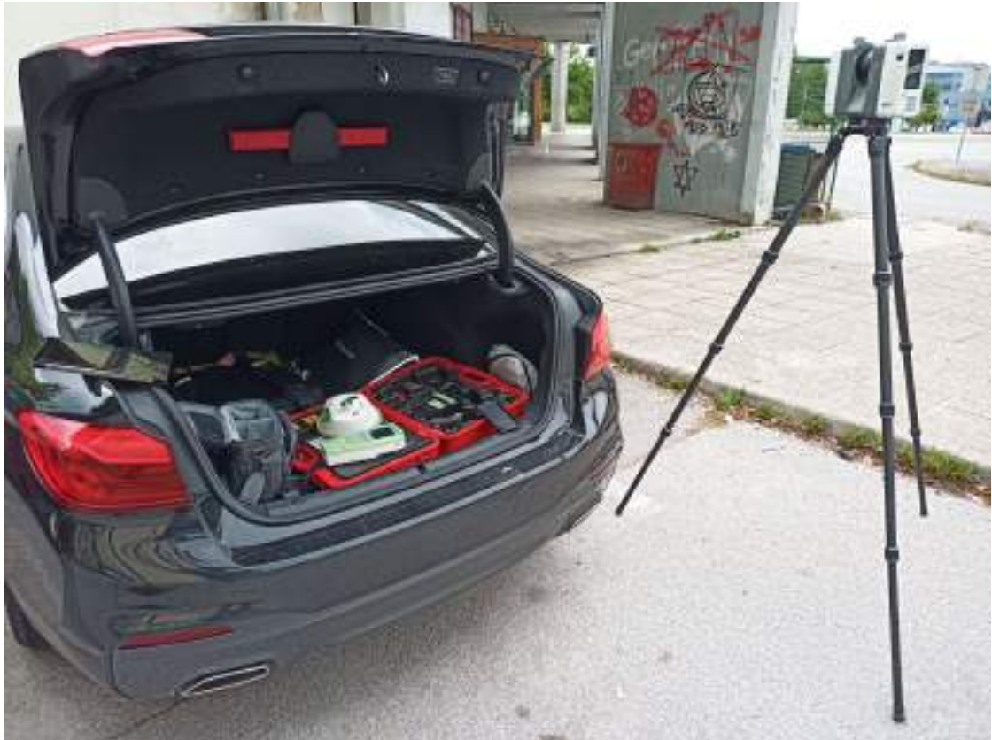
Slika 13 Priprava pred pričetkom del 3D laserskega skeniranja
