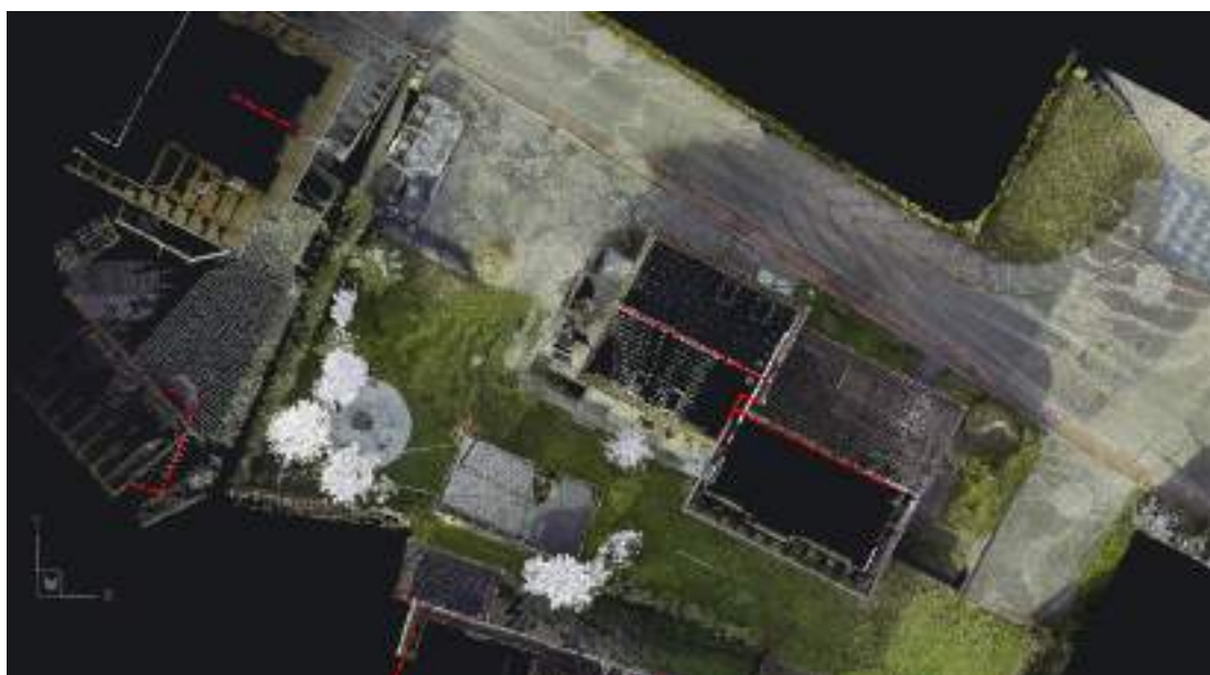
Slika 29 Prikaz primerjave georeferenciranega oblaka točk na podlagi geodetskega načrta
