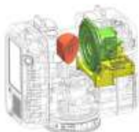
Slika 8 Prikaz pogonskega sklopa za vrtenje leče in zajemanje odbitih žarkov od skeniranega telesa
