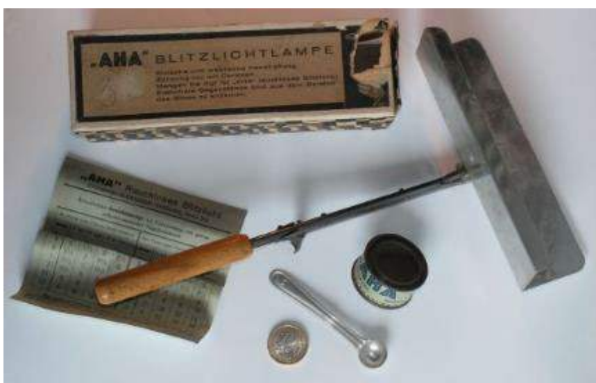
Slika 28: Sistem za bliskavico v prahu
