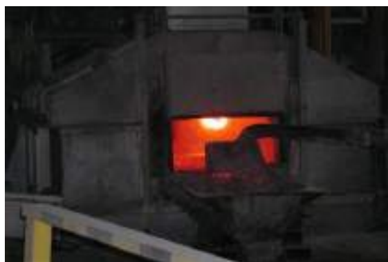
Slika 4: Posnemanje žlindre v odстойni peči
