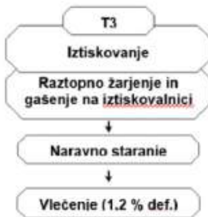
Slika 6: Shema termomehanske obdelave - stanje T3
