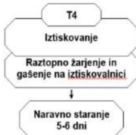
Slika 5: Shema termomehanske obdelave - stanje T4
