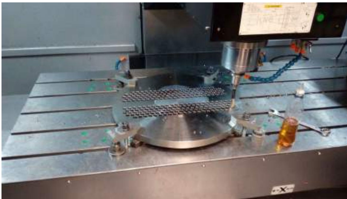
Slika 33: Povrtavanje cevnih plošč
