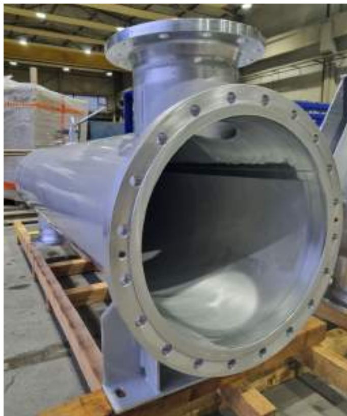
Slika 38: Prikaz po luženju in pasiviranju
