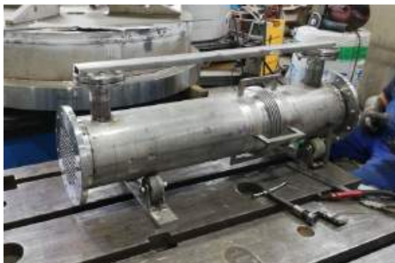
Slika 16: Sestava enega tipa izmenjevalca
