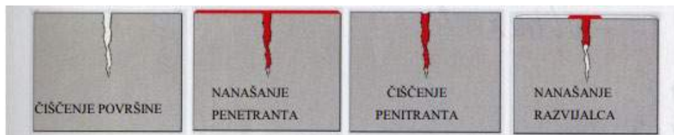
Slika 41: Prikaz metode penetriranja
