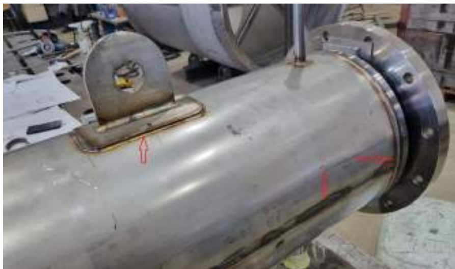
Slika 37: Izmenjevalec pred luženjem
