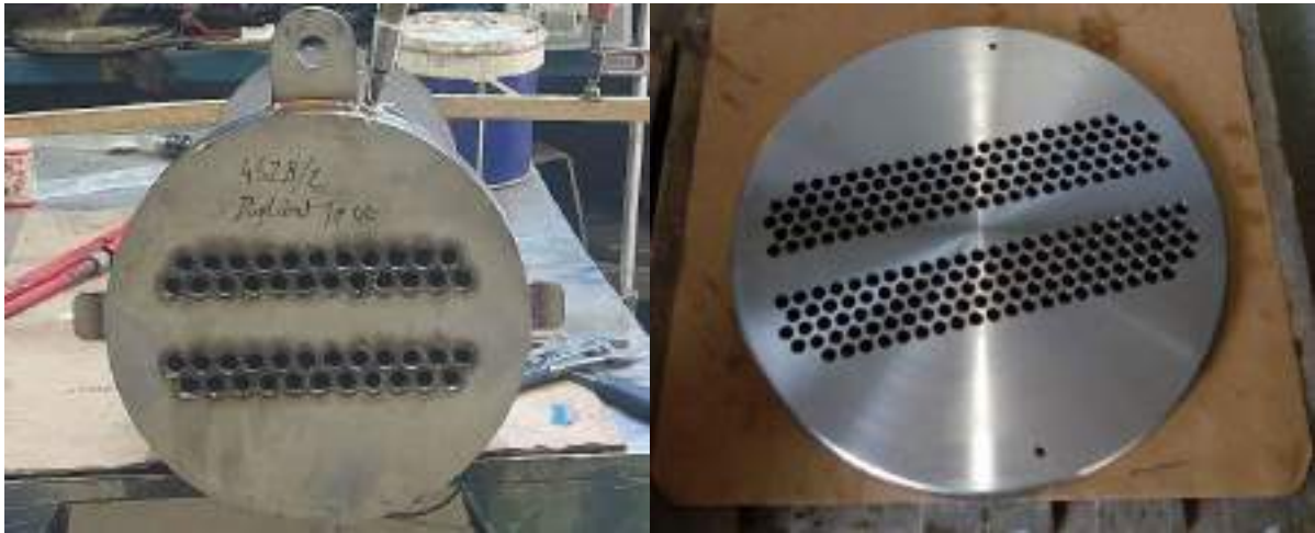
Slika 7: Primer cevnih plošč z različnim številom cevi
