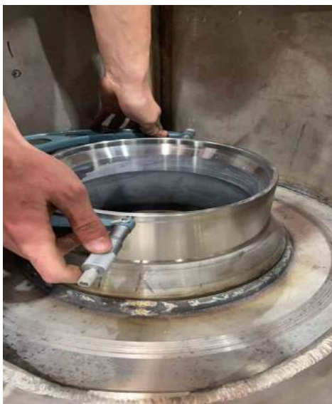
Slika 21: Vmesna kontrola z mikrometrom
