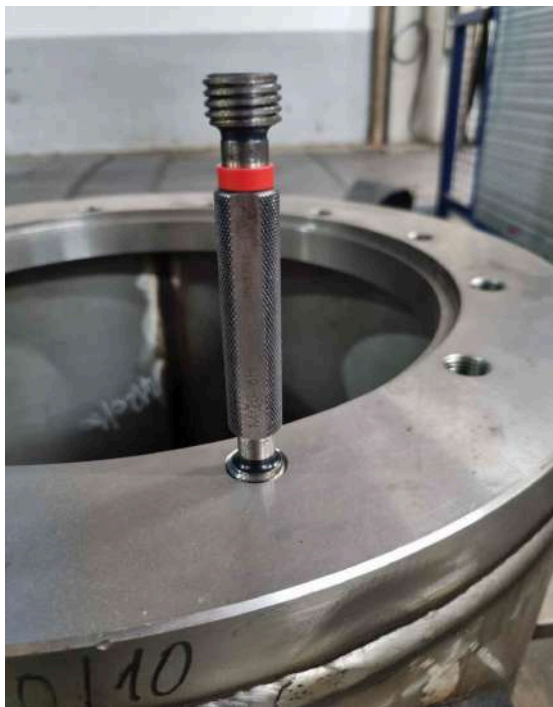
Slika 23: Kontrola z navojnim trnom za metrične navoje
