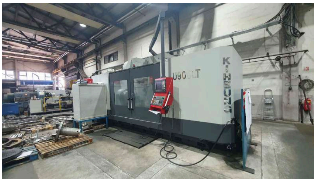
Slika 36: Rezkalni stroj KIHEUNG U900LT
