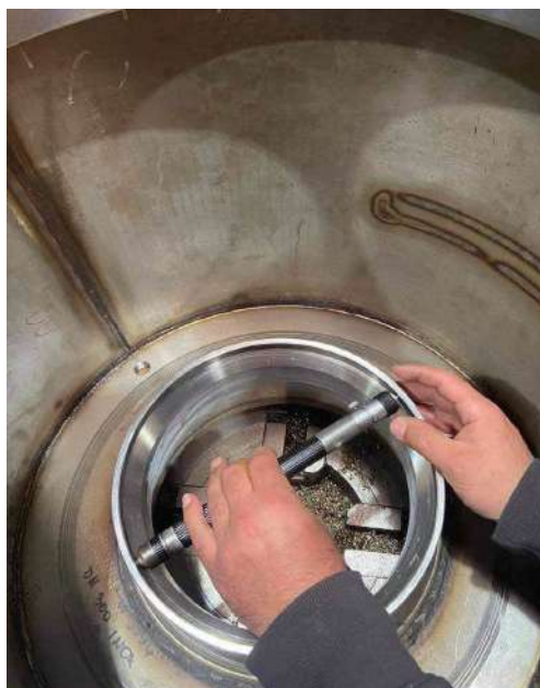
Slika 22: Vmesna kontrola s paličnim mikrometrom za notranje premere
