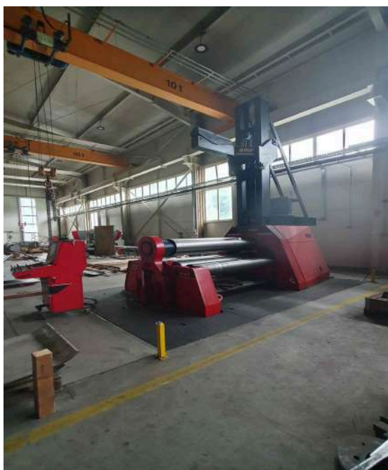
Slika 20: Upogib s tremi valji
