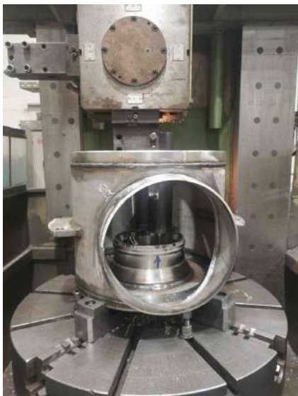
Slika 38: Ohišje med obdelavo pri vertikalnem struženju
