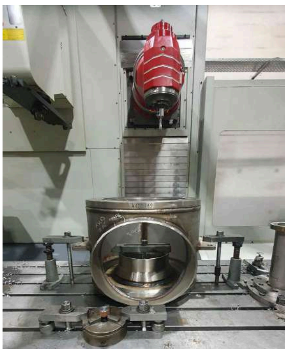
Slika 37: Vpeto ohišje na mizo stroja pred obdelavo
