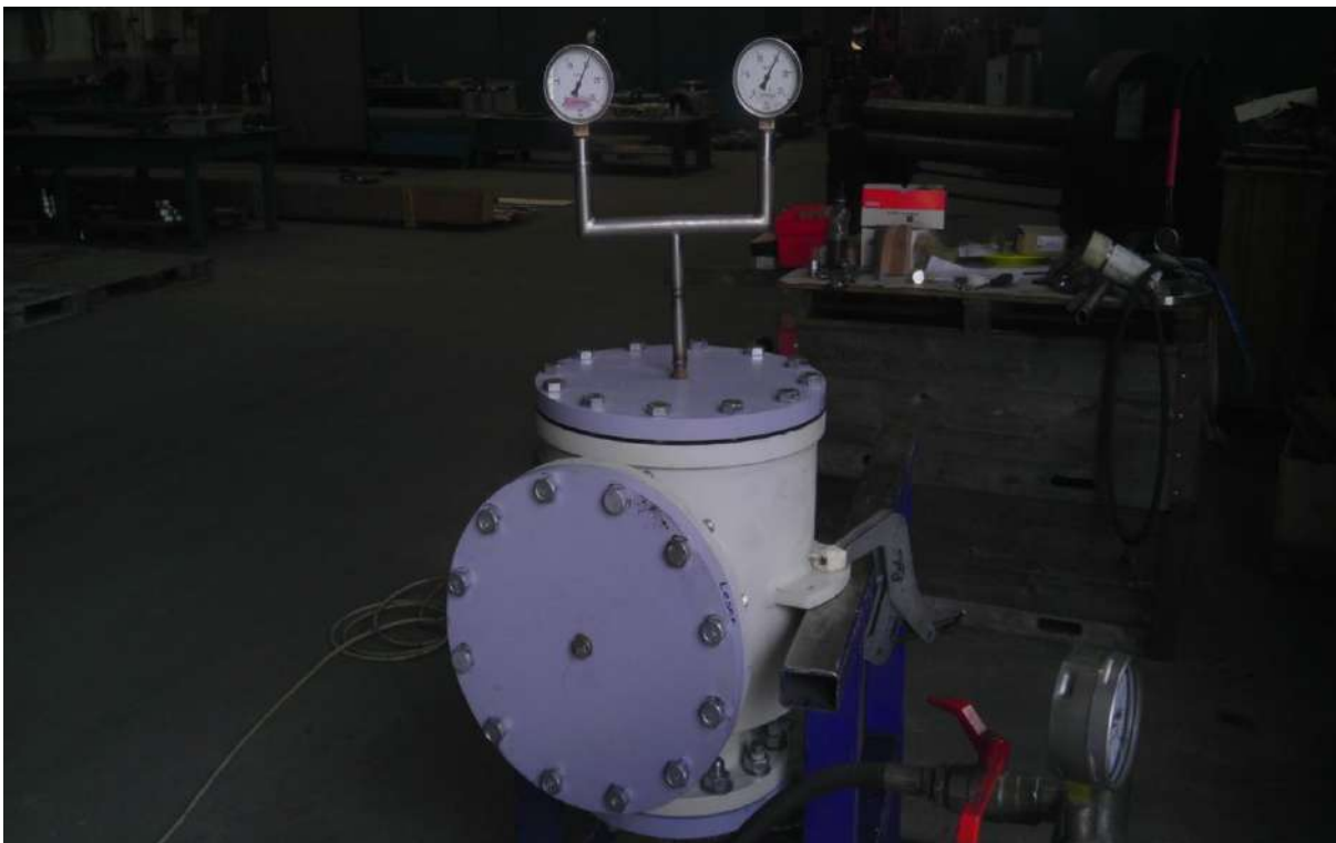
Slika 26: Tlačni preizkus visokotlačnega ventila
