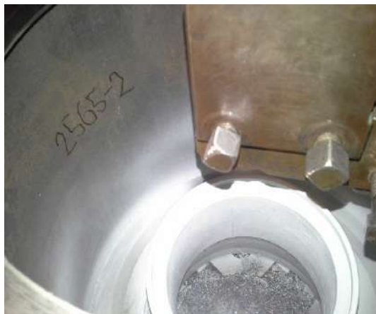
Slika 24: Preizkus s penetranti 1
