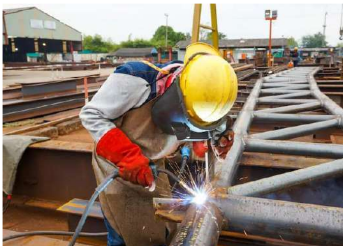
Slika 19: Obločno varjenje s polnjenjem
