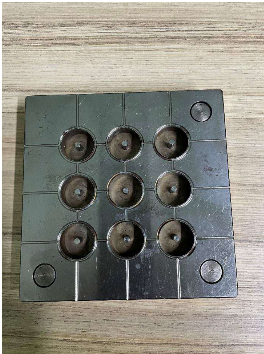
Slika 35: Kalup, izdelan na CNC rezkalnem stroju
