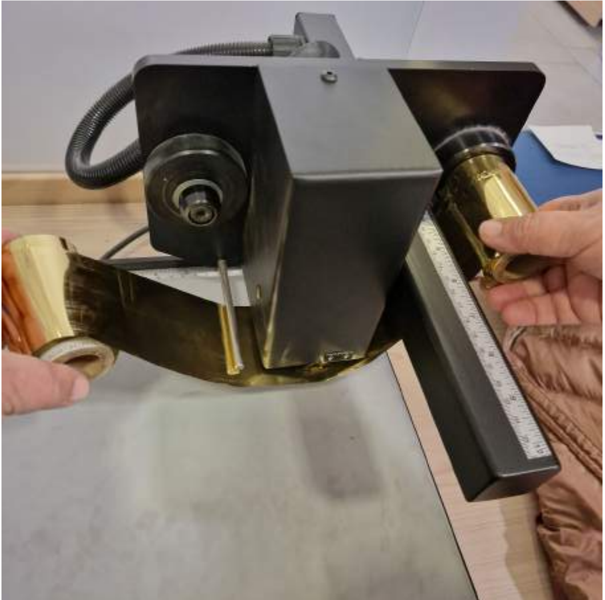
Slika 10: Vstavljanje termične folije.
