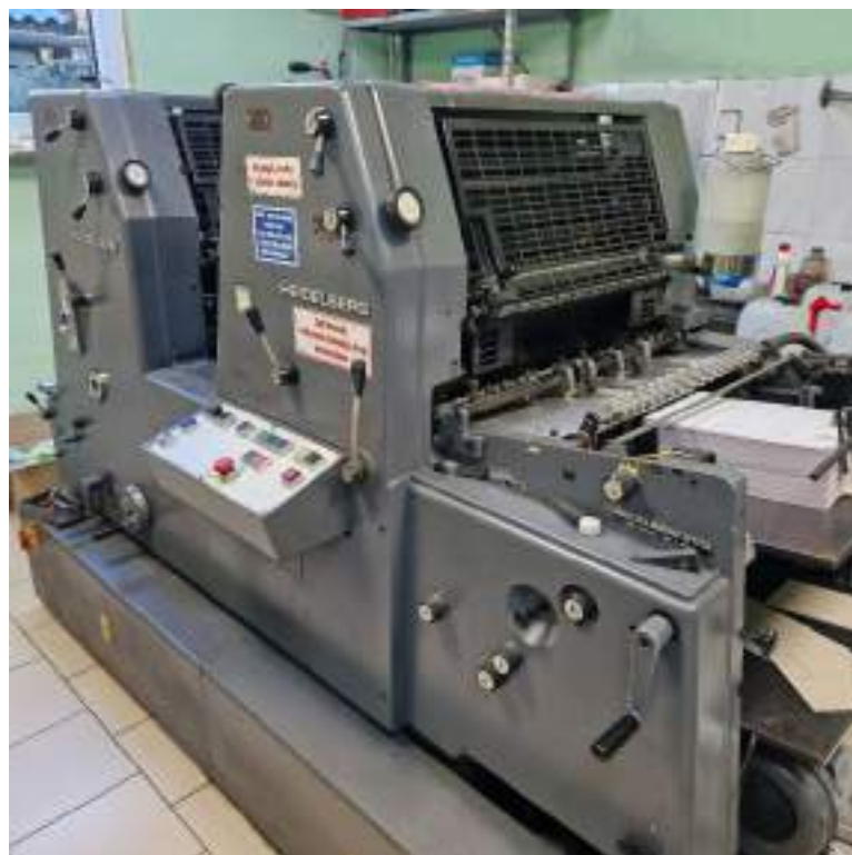
Slika 3: Dvobarvni stroj za ofsetno tehniko – GTO 52.
