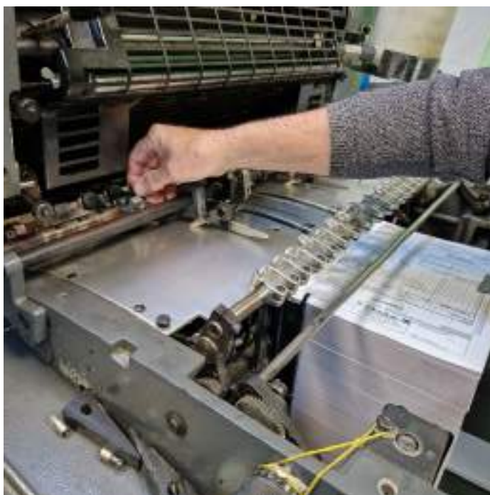
Slika 27: Nastavitev markirke za smer teka materiala.
