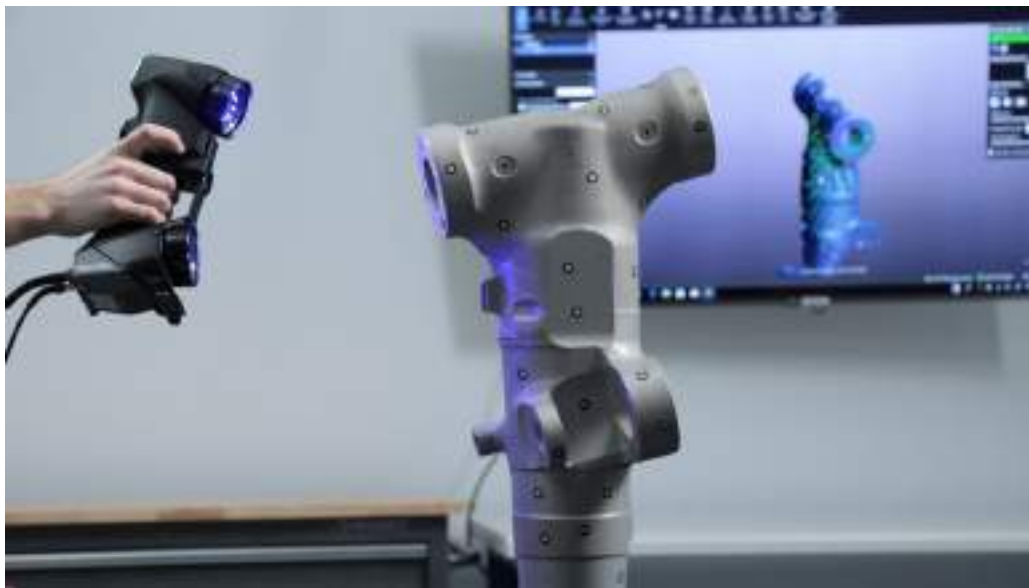
Slika 21: Skeniranje modela s 3D skenerjem
