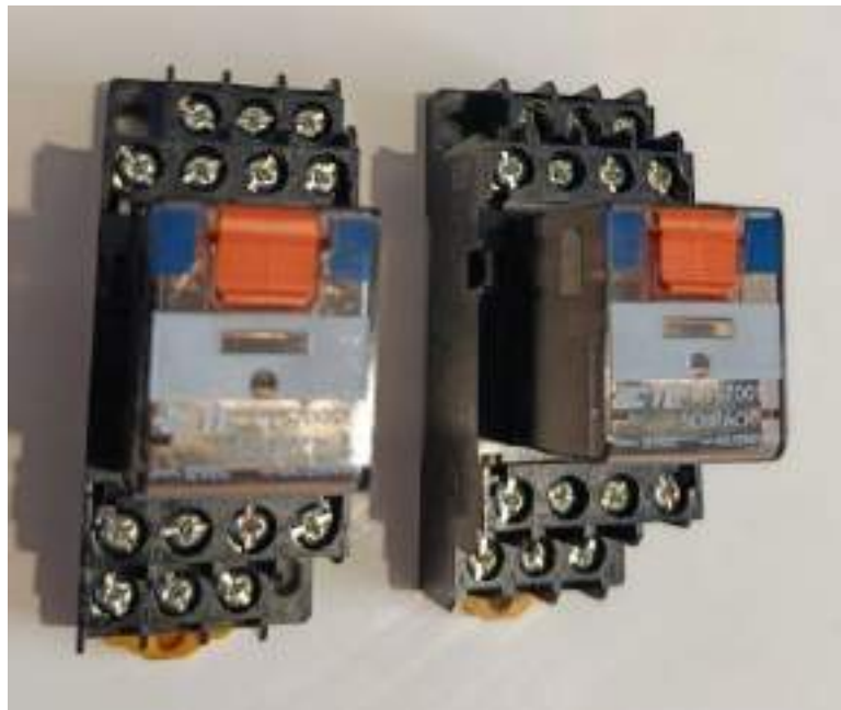
Slika 60: Niskonapetostni releji, potrebni za delno avtomatsko delovanje
