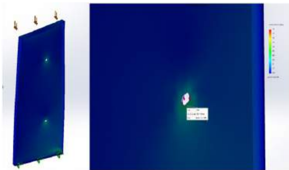
Slika 40: Deformacija in povečanje napetosti
