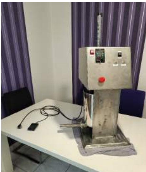
Slika 54: Sestava polnilke z vsemi komponentami
