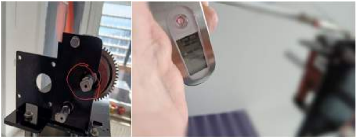
Slika 35: Merjenje potrebne sile na ročico
