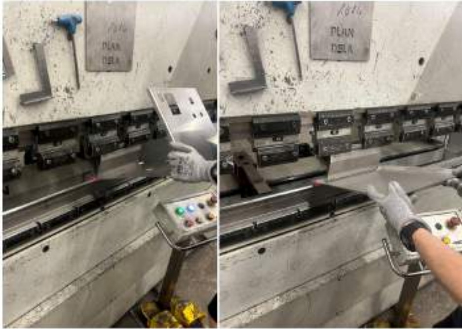
Slika 46: Krivljenje pločevine s strojem FUTURA 160-30
