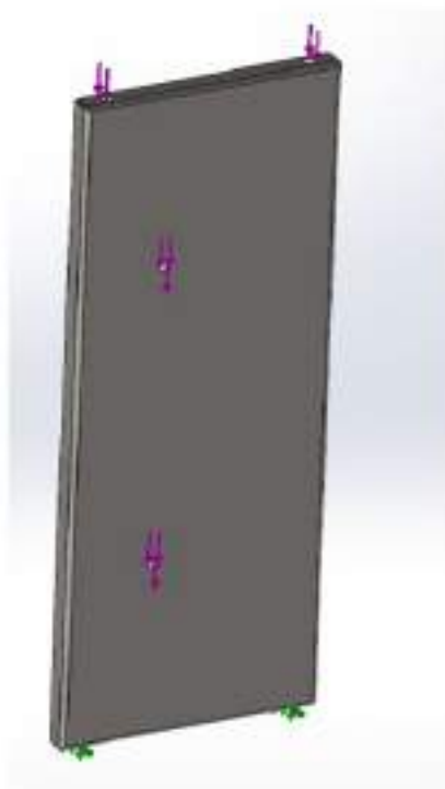
Slika 38: Predpisane obremenitve na nosilec
