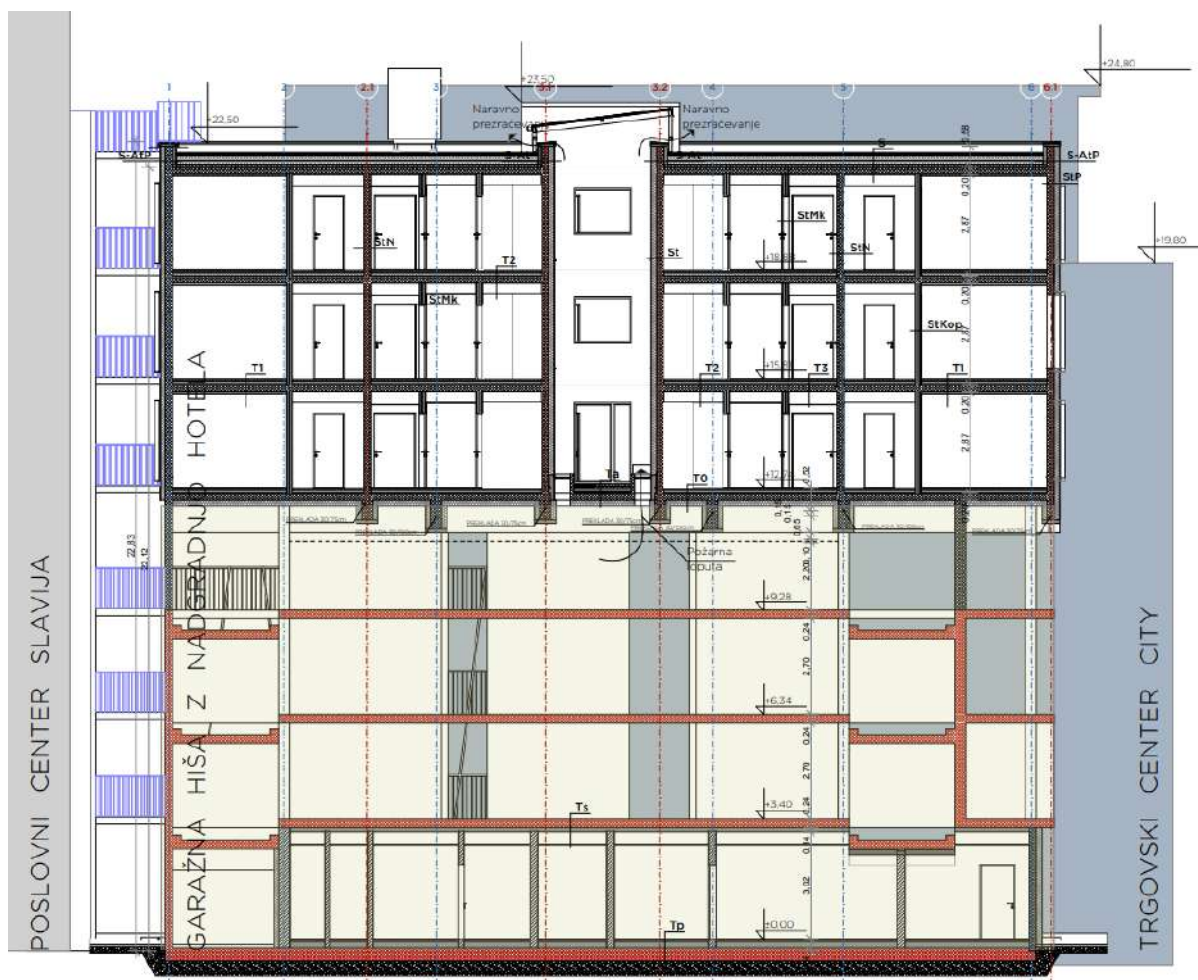
Slika 1: Tipski prečni prerez predvidene nadzidave
