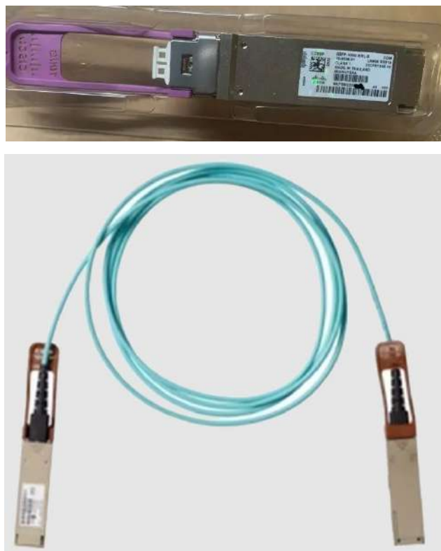
Slika 19: Primer priključnih kablov DAC- in QSFP-modula
